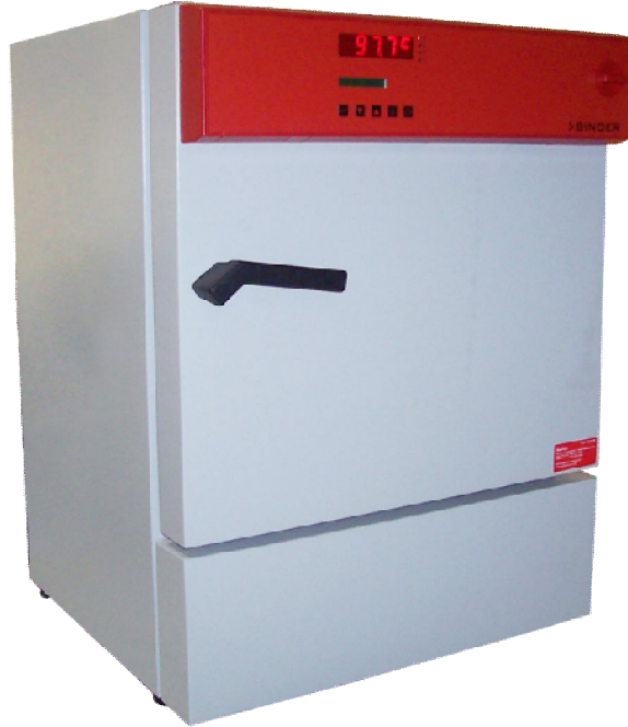
Şekil 6.6. Binder marka etüv.
