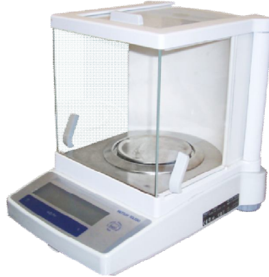
Şekil 6.5. Mettler Toledo marka hassas terazi.
