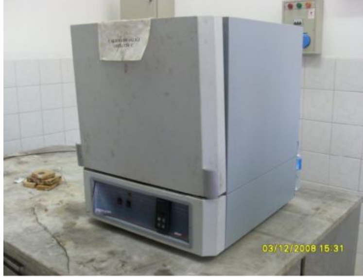
Şekil 6.1. Alser marka protherm model PID kontrollü elektrikli direnç fırını.
