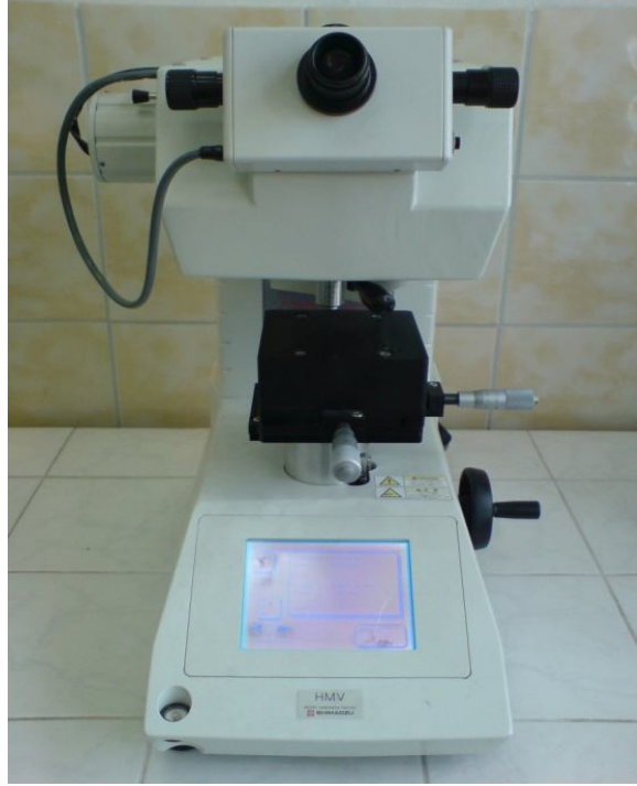
Şekil 6.3. Schimadzu marka HMV Model mikrosertlik cihazı.
