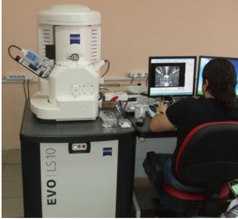
Şekil 6.10. Mikroyapı incelemelerinde kullanılan taramalı elektron mikroskobu (SEM).
