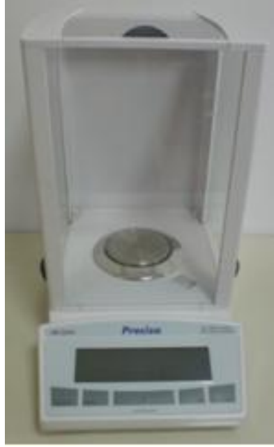
Şekil 6.6. Ağırlık kayıplarının belirlenmesinde kullanılan Precisa marka XS 220A model hassas terazi.
