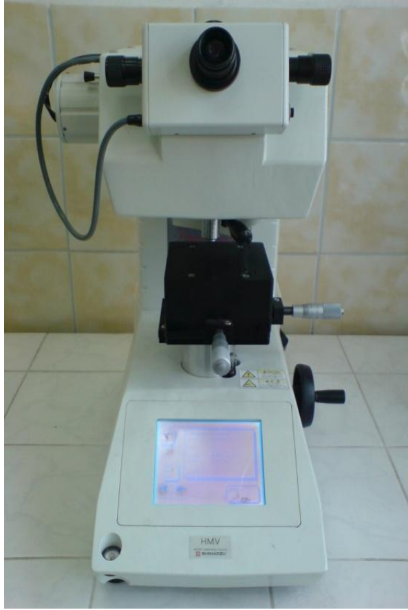
Şekil 6.4. Sertlik ölçümlerinde kullanılan mikrosertlik test cihazı.
