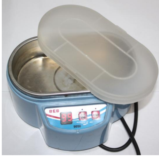
Şekil 6.5. Numune temizleme işlemlerinde kullanılan BEB marka ultrasonik temizleme cihazı.
