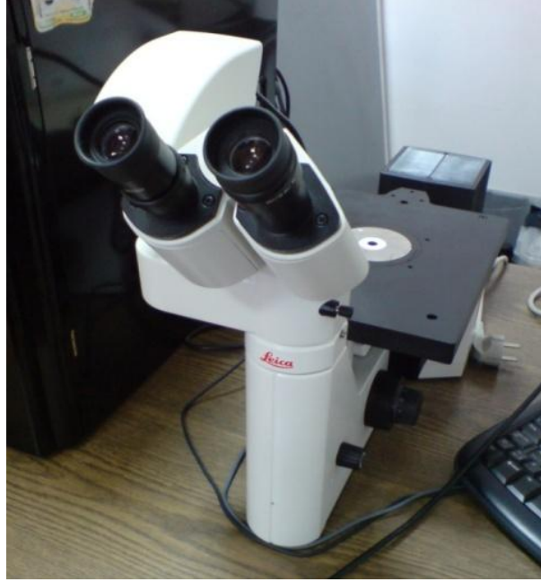
Şekil 6. 3. Mikroyapı incelemelerinde kullanılan optik ışık mikroskobu.
