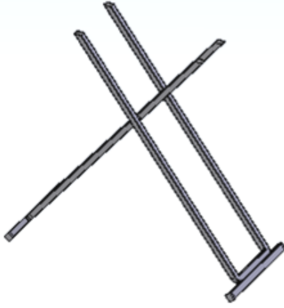
Şekil 6.8. Taşıyıcı Kol tasarım parametresi Dörtlü2 kategori, Ayak Türü tasarım parametresi I kategori, Profil Kesit tasarım parametresi Kare kategori platform ayağı modeli.
