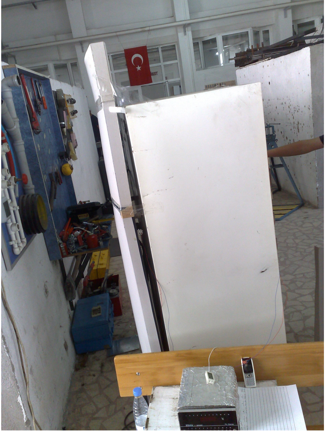
Şekil 4.1. Doğal taşınımlı ve bacalı doğal taşınımlı deney seti olarak kullanılan soğutma sisteminin genel görünümü
