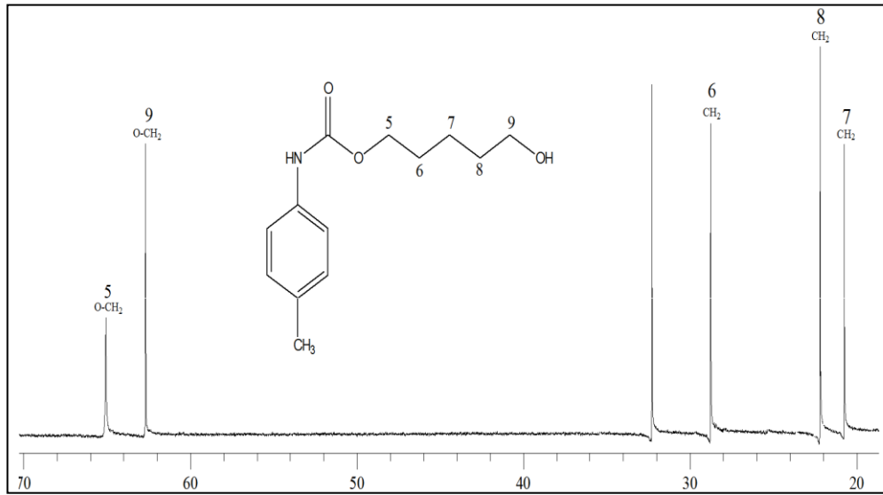
Şekil 4.34. C3 bileşiğine ait 5, 6, 7, 8 ve 9 nolu karbonların ^{13}\text{C} NMR spektrumları (75 MHz, çözücü= \text{CDCl}_3 ).
