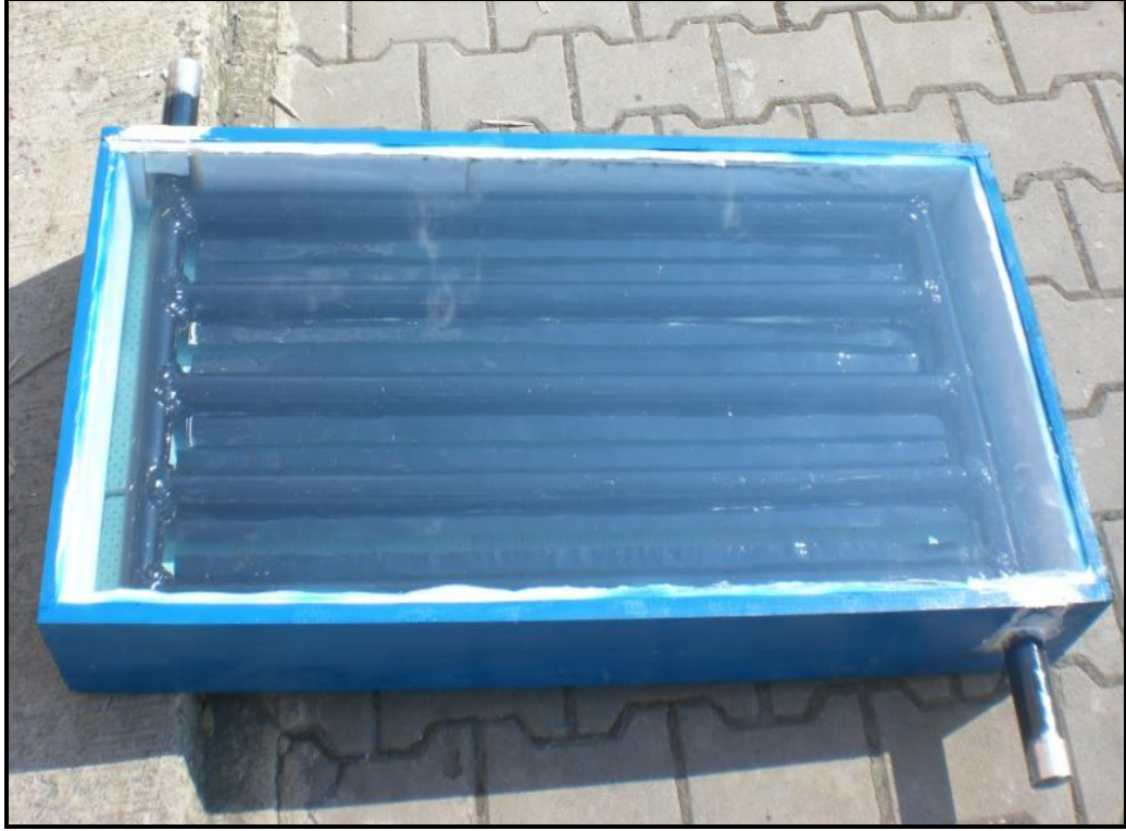
Şekil 5.4. Alüminyum borulu bakır kanatçıklı kolektör.
