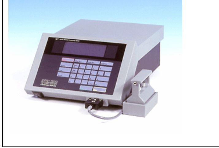
Şekil 3.4. QTM-500 cihazı ile ısı iletkenlik katsayısı deneyi.
