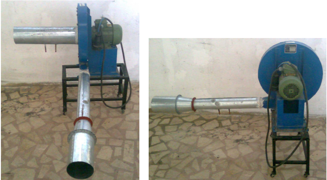
Şekil 5.9. Yatay eksenli helezonik rüzgâr türbininin denenmesinde kullanılan fan
