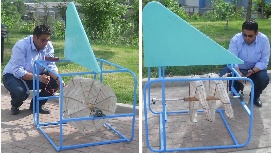
Şekil 5.8. Yatay eksenli helezonik rüzgâr türbininin dış ortamda denenmesi
