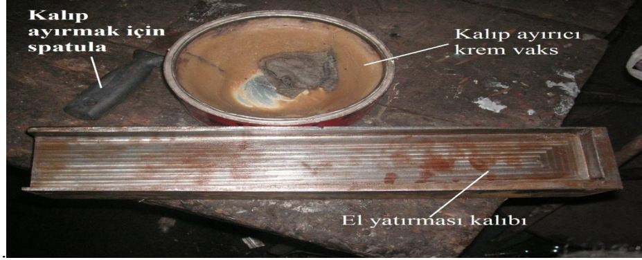
Şekil 4.5. Kalıp ayırıcı vaksın kalıba uygulanması.
