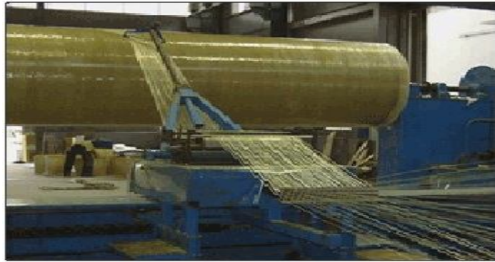
Şekil 2.18. İplik sarma yöntemi [33].
