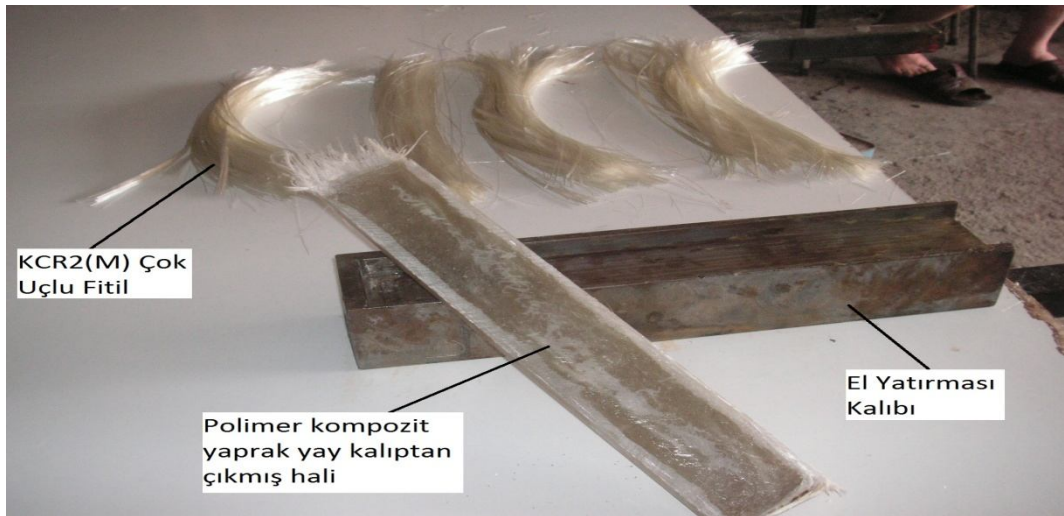
Şekil 4.12. Polimer kompozit yayın el yatırması kalıbından çıkarılmış hali.
