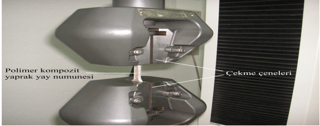
Şekil 5.7. Çekme deney işlemi.
