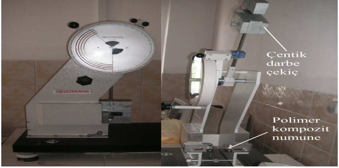
Şekil 5.3. Deneylerde kullanılan çentik darbe cihazı ve numune.
