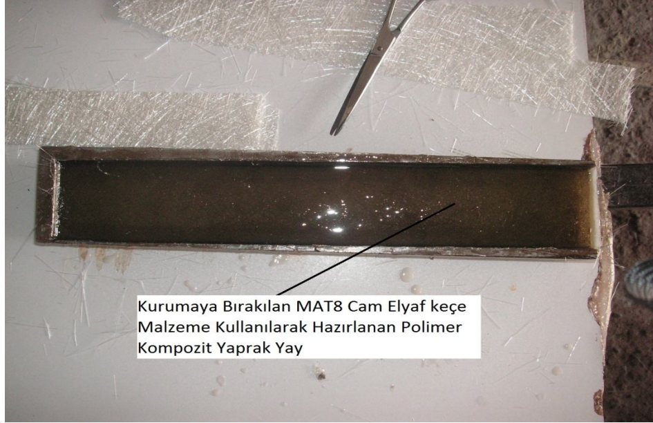
Şekil 4.11. Kurumaya bırakılan MAT8 cam elyaf keçeden üretilen yaprak yay.
