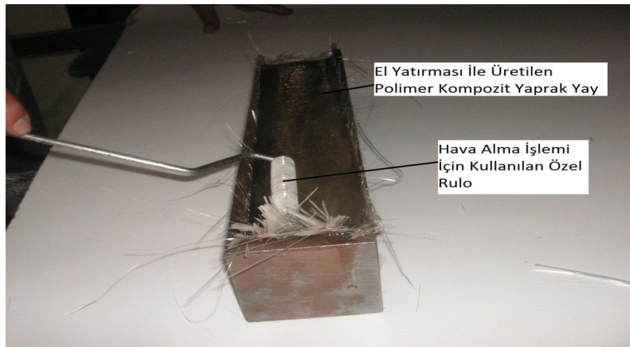
Şekil 4.10. El yatırması yöntemi hava alma işlemi.
