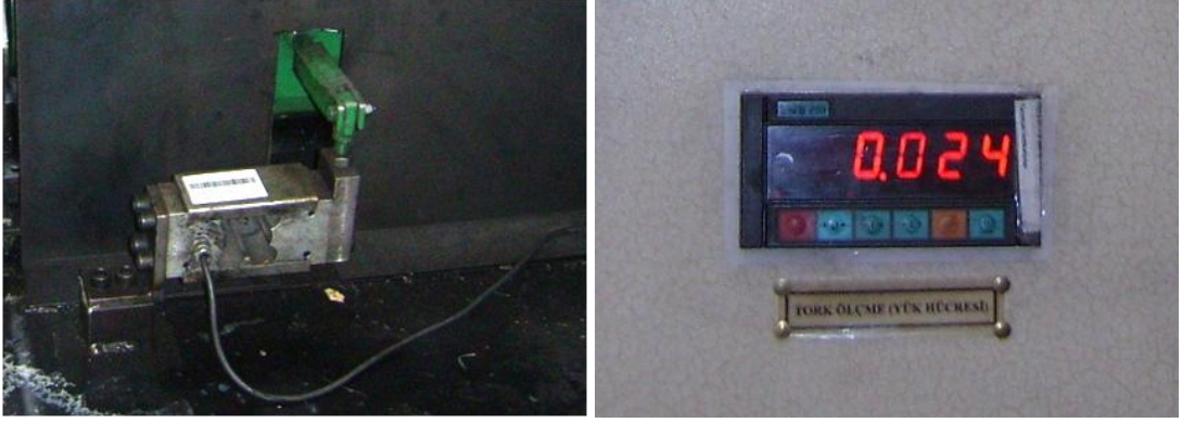
Şekil 5.7. Yük hücresi ve indikatörün görünümü
