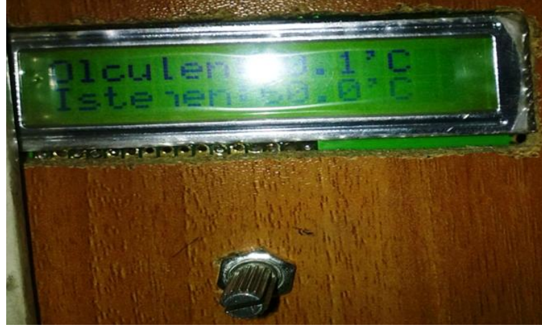
Şekil 5.28. Mikro-denetleyici kontrollü elektronik ısıtma devresinde kontrol düğmesi ve LCD ekranı
