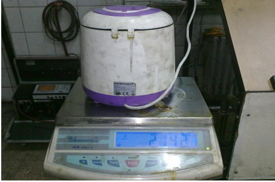
Şekil 5.6. Yakıt tüketimi ölçmek için hassas terazi
