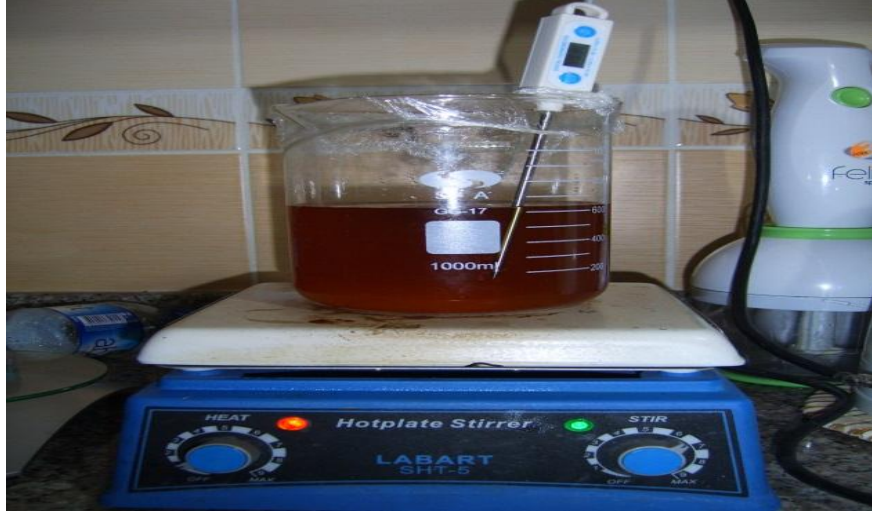
Şekil 5.19. Dijital termometre ile reaksiyon sıcaklığının ölçülmesi
