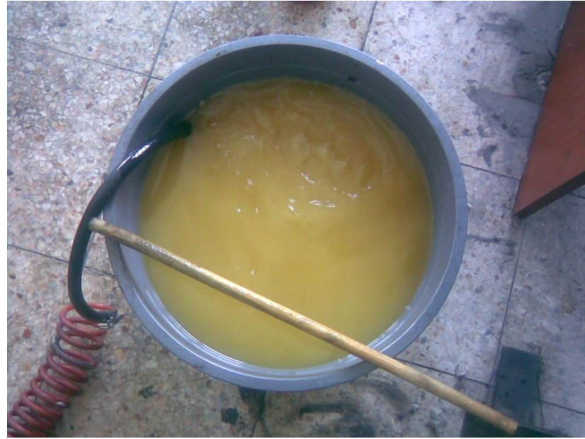
Şekil 5.24. Kabarcık yöntemi ile biyodizelin yıkanması
