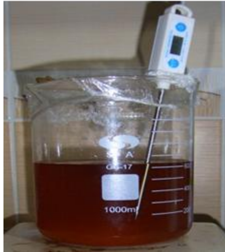
Şekil 5.12. Dijital termometre ile Reaksiyon sıcaklığının ölçülmesi
