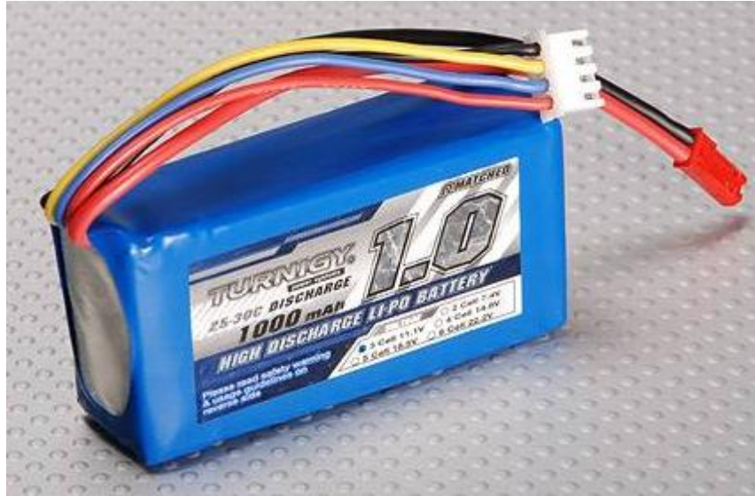
Şekil 4.3. Enerji depolama ünitesi
