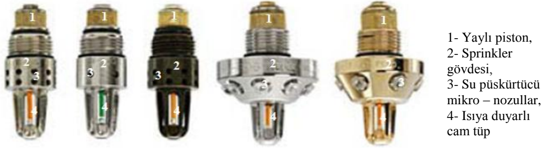
Şekil 3.1. Su sisi sprinkler başlıkları [43].
