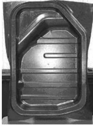
Şekil 1.6. Kim ve vd. şekillendirdiği bir otomobil yakıt tankı [19]
