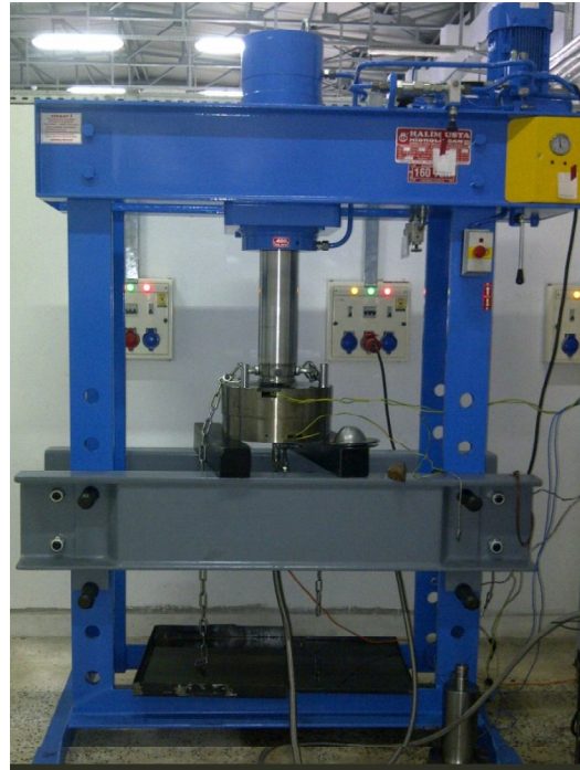
Şekil 5.4. Asıl şekillendirme deneylerinin yapıldığı hidrolik pres
