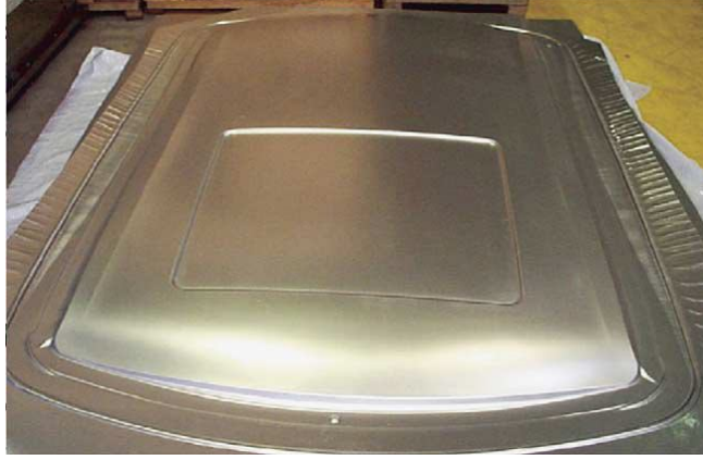
Şekil 1.3. Sac hidroform metoduyla üretilmiş lüks bir otomobil tavan elemanı. [17]
