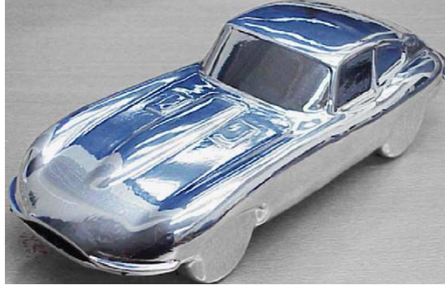
Şekil 1.4. Bir alüminyum tüpün sıcak hidro şekillendirilmesiyle elde edilmiş otomobil modeli, uzunluğu yaklaşık 250mm [17]
