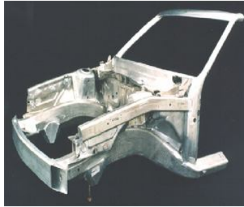
Şekil 2.1. Hidrolik şekillendirme yoluyla üretilen alüminyum otomobil gövdesi [39]
