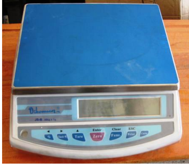
Şekil 6.3. LPG yakıt tüketimi ölçümünde kullanılan elektronik terazi.
