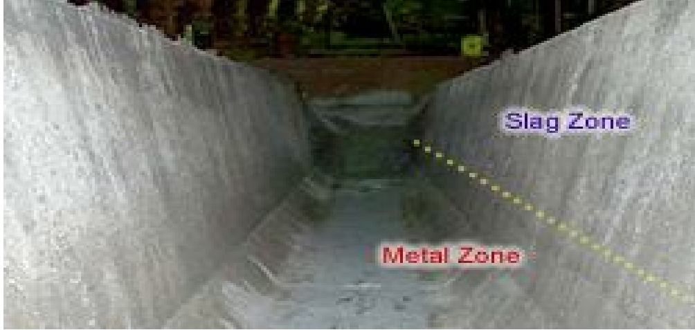
Şekil 4.4. Yüksek fırın kanalında cüruf ve metal bölgeleri [46].
