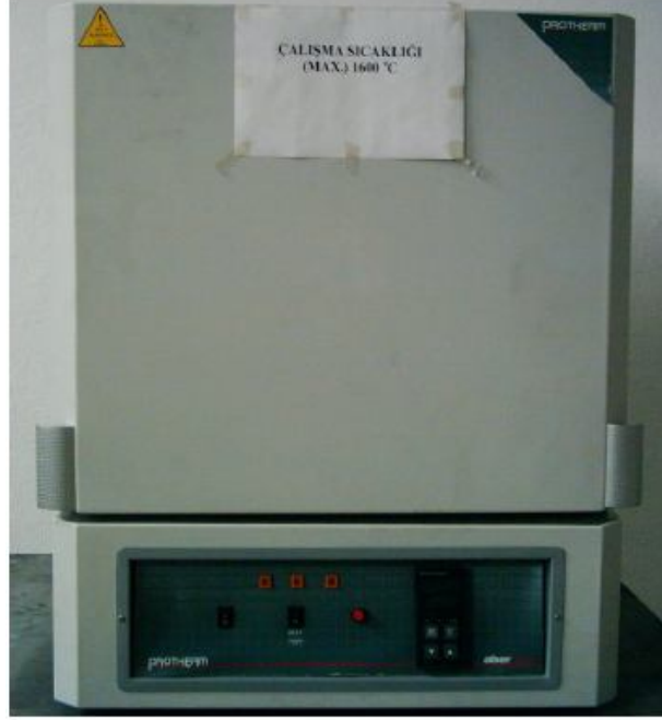
Şekil 5.2. Isıl işlem uygulamalarında kullanılan Protherm marka ısıl işlem fırını.
