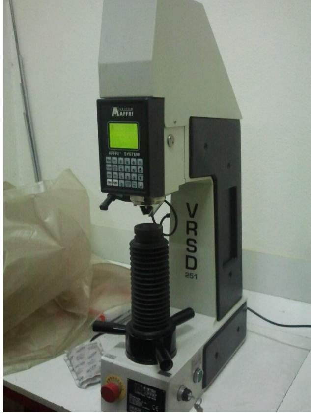
Şekil 5.6. AFFRI SYSTEM marka ve VRSD-251 model universal makro sertlik ölçüm cihazı.
