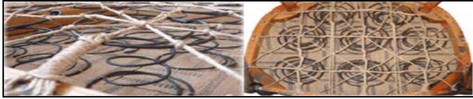
Şekil 1.34. Sabit teloraya yapılmış döşeme zemini [2].
