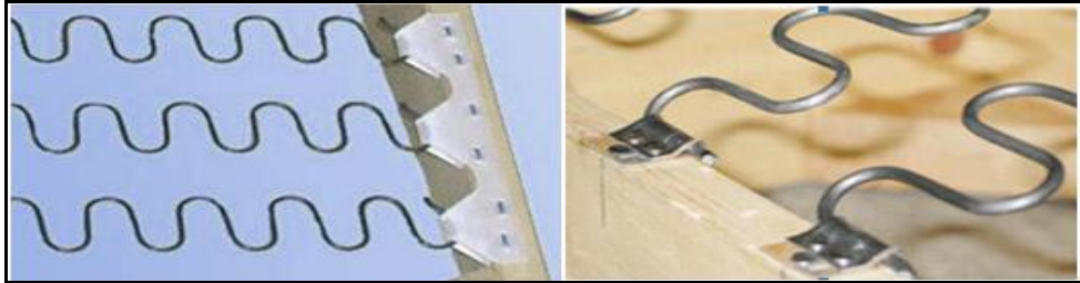
Şekil 1.31. Sabit teloraya yapılmış döşeme zemini [2].
