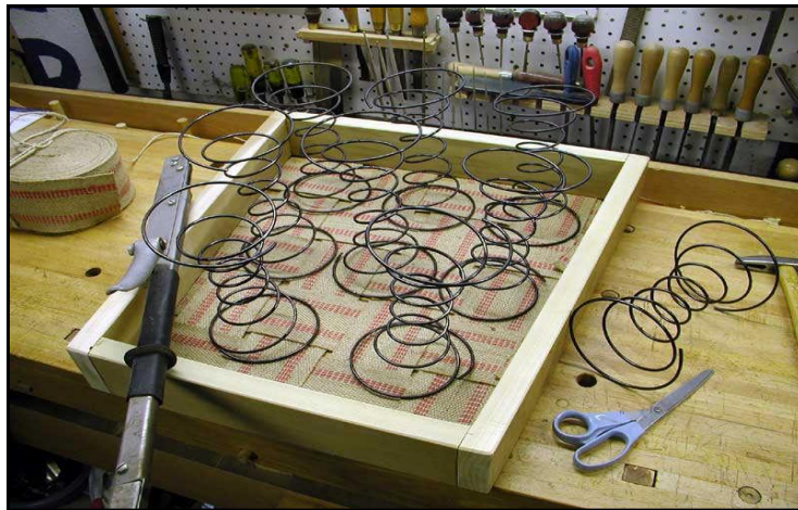
Şekil 1.41. Kolan üzerine helezoni yayların bağlanması [2].
