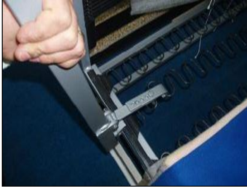
Şekil 1.21. Yay gergi aletinin kullanılışı [2].
