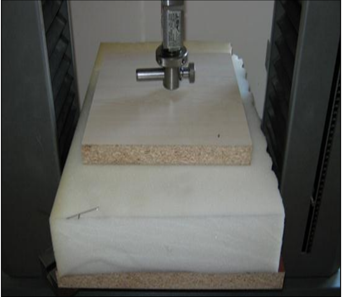
řekil 3.4. Sertlik deęeri ölçümü
