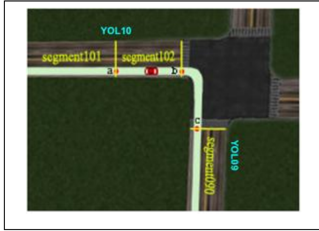
Şekil 5.10. Segment ve kavşak bağlantıları.
