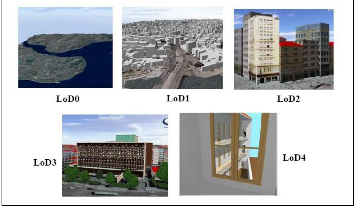
Şekil 2.8. OGC tarafından 3B kent modelleri için belirlenmiş ayrıntı düzeyleri.
