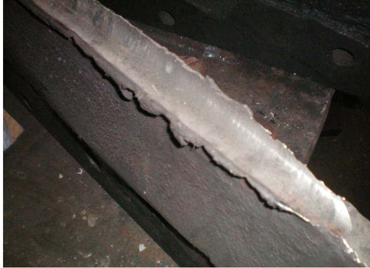
Şekil 6.1. Aşınmış bir doğrultma mastarı görüntüsü.
