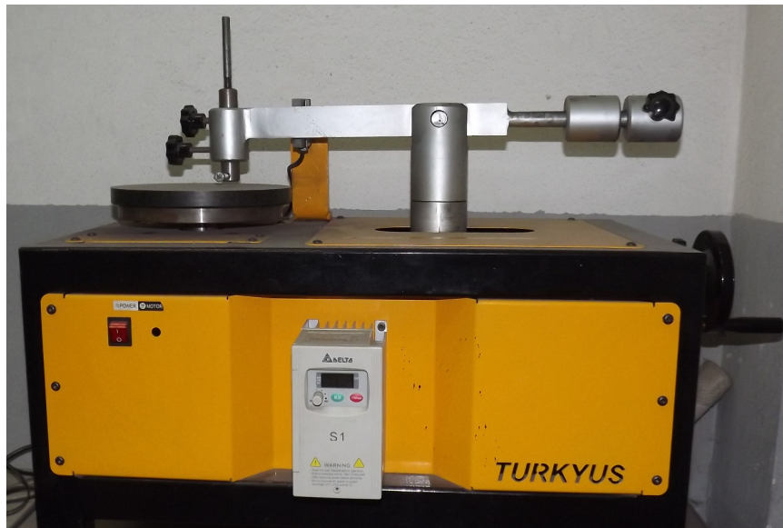
Şekil 6.7. Aşınma deneylerinde kullanılan aşınma cihazı.
