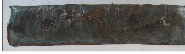
Şekil 6.3. Dolgu kaynağı yapılmış numune görüntüsü.
