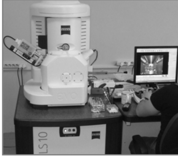
Şekil 6.4. Mikroyapı incelemelerinde kullanılan taramalı elektron mikroskobu.
