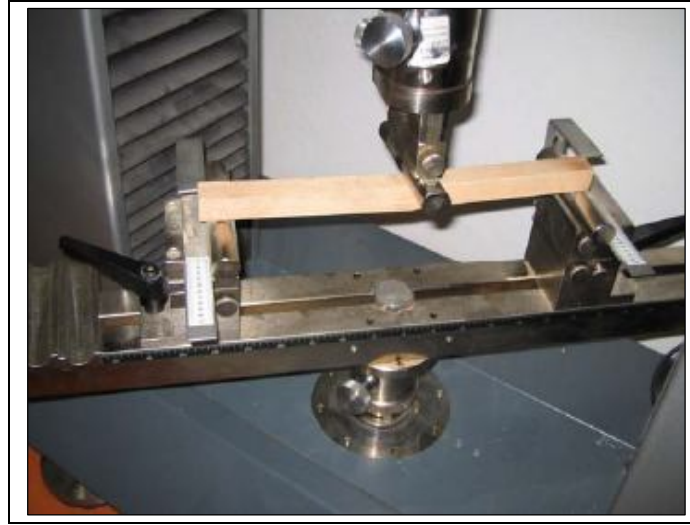
Şekil 2. 17. Üniwersal test cihazında eğilme testlerinden görünüm
