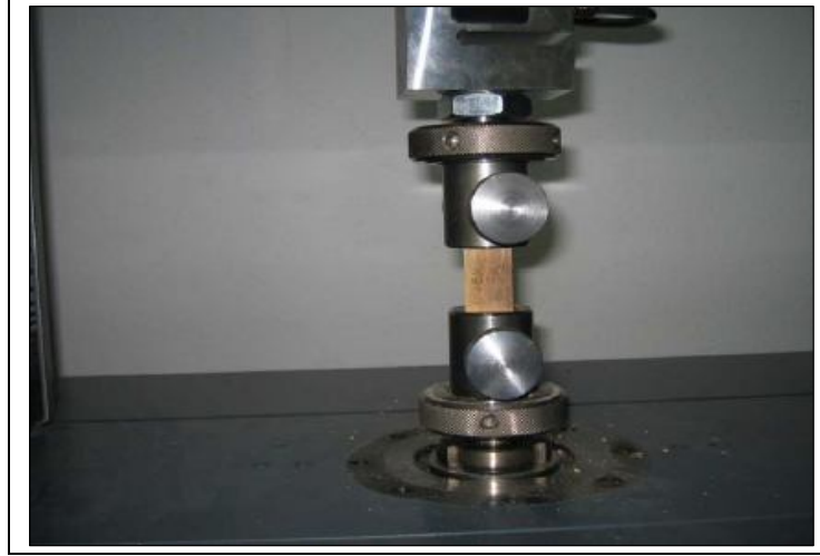
Şekil 2. 19. Üiversal test cihazında liflere paralel basınç direnci testi.
