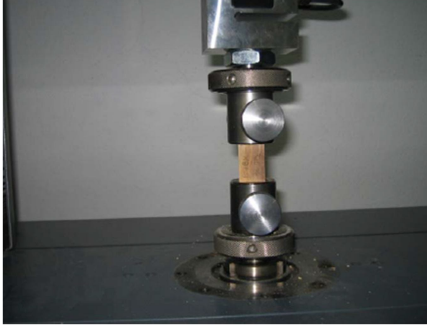
Şekil 2.18. Üniversal test cihazında liflere paralel basınç direnci testi.
