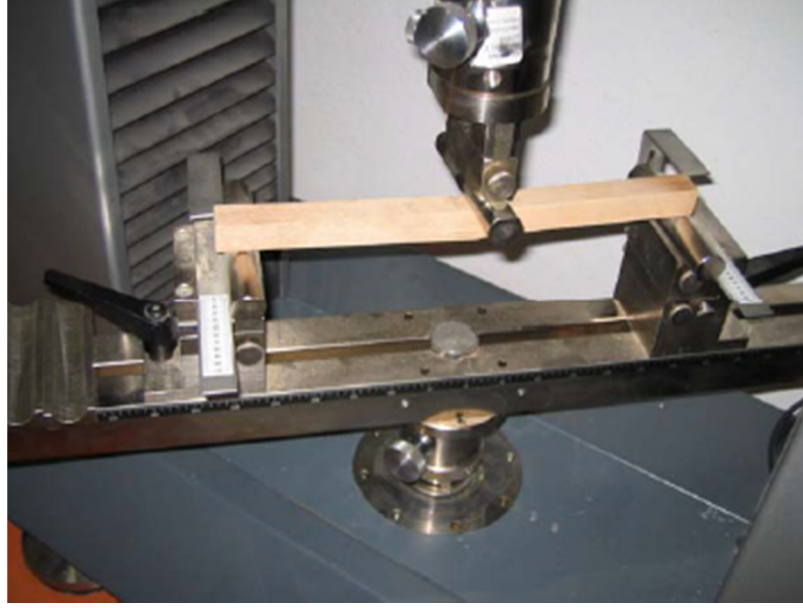
Şekil 2.17. Üniversal test cihazında eğilme testlerinden görünüm.
