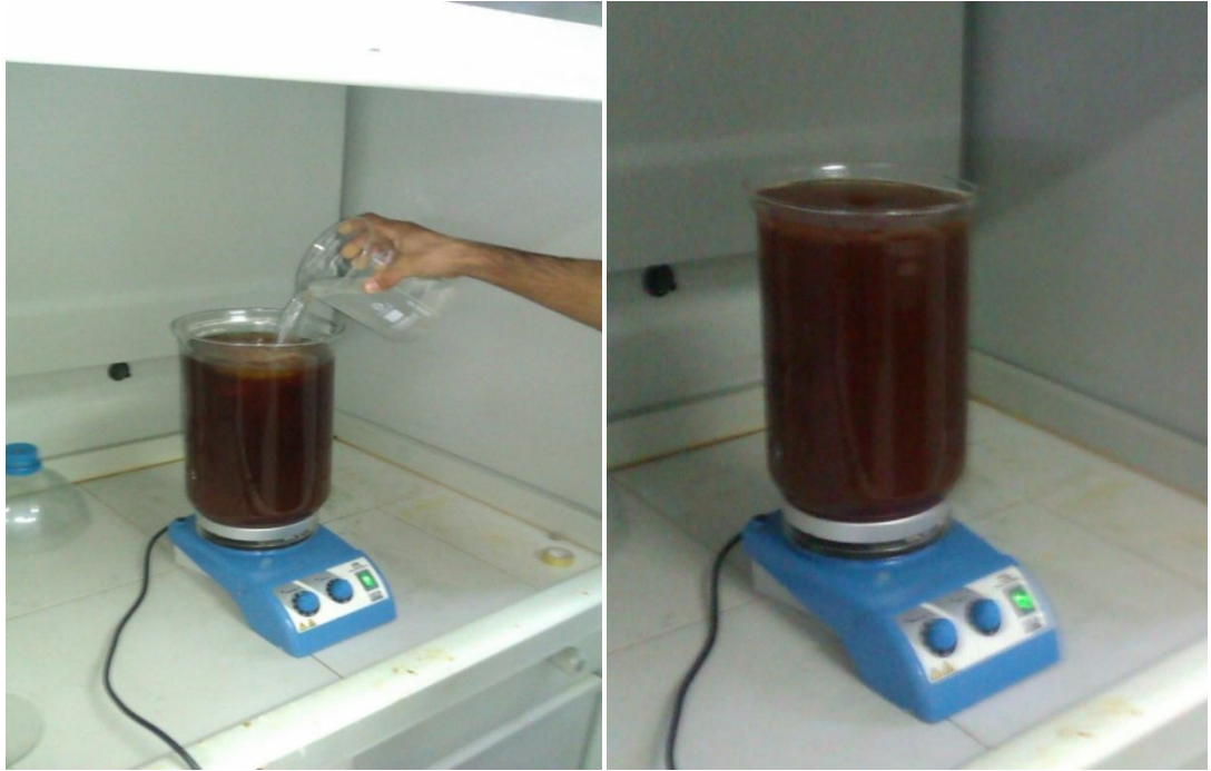
Şekil 5.3. Atık balık yağı içerisine metoksit karışımının eklenmesi ve transesterifikasyon reaksiyonu gerçekleşen karışımın ilk 20. dakikadaki görüntüsü.
