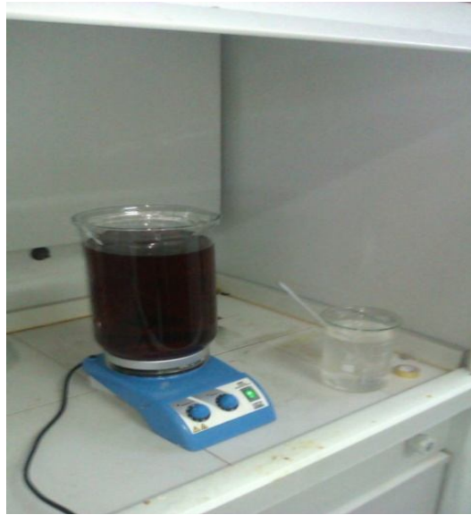
Şekil 5.2. Atık balık yağı içerisindeki suyun buharlaştırılması.
