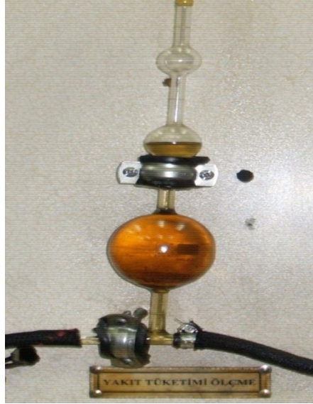
Şekil 5.12. Yakıt tüketimi ölçüm düzeneği.
