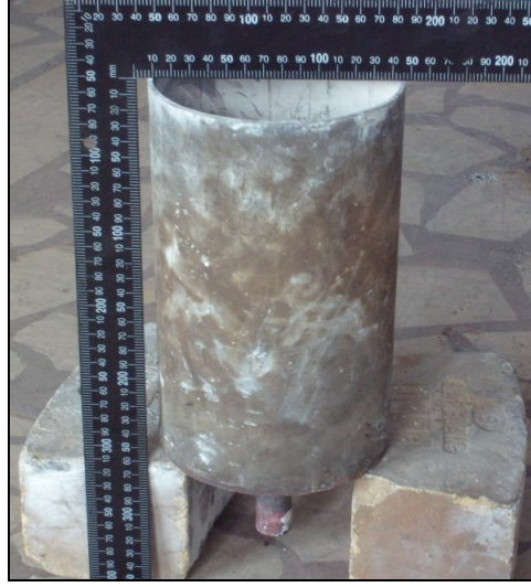
Şekil 4.2. Ergitme işleminde kullanılan çelik pota resmi.
