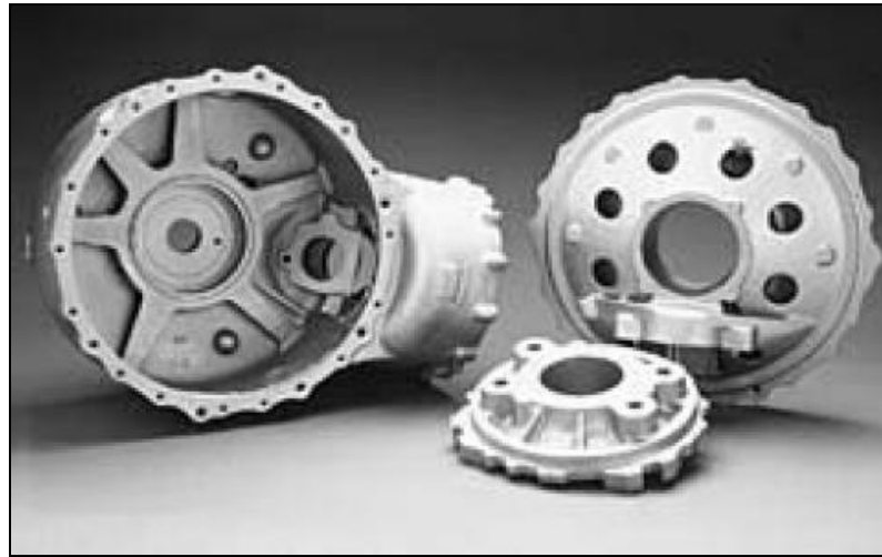
Şekil 2.8. WE43 alaşımından dökülmüş helikopter vites kutusu [15,23].
