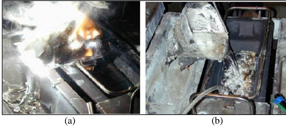
Şekil 3.5. Mg alaşımı dökümlerinde gaz kullanımı a) atmosfer ortamı, b) SF 6 [40].
