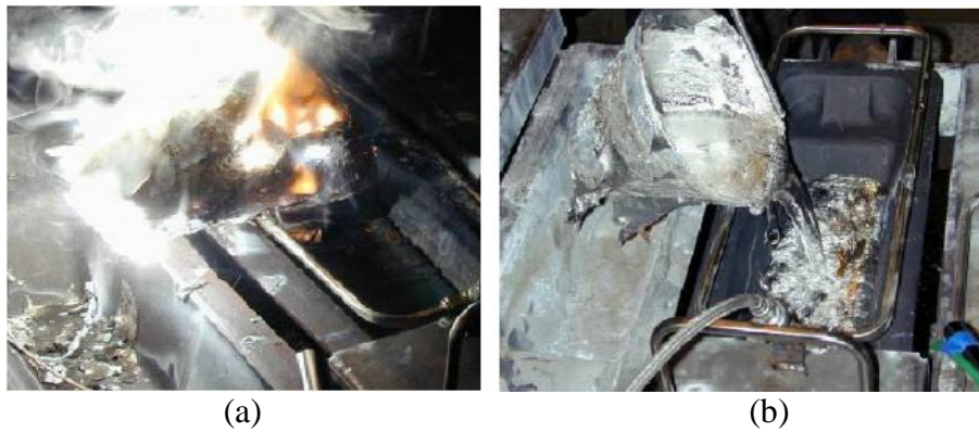
Şekil 2.25. Mg alaşımı dökümlerinde gaz kullanımı a) Atmosfer ortamı, b) SF 6 (Hillis, 2002).
