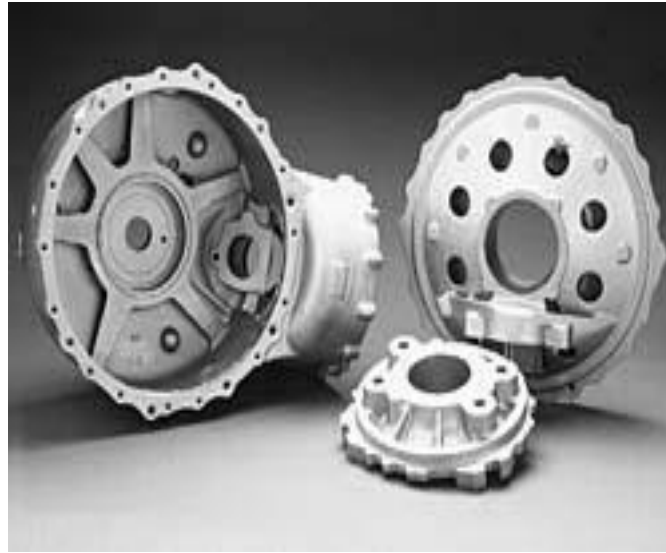
Őekil 2.8. WE43 alařımından dklmő helikopter vites kutusu (Mordike and Kainer, 1998, Őaludov, 2005).
