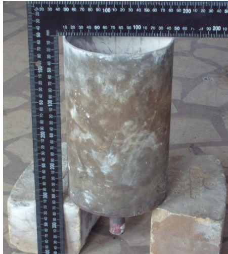
Şekil 3.2. Ergitme işleminde kullanılan paslanmaz çelik pota resmi.
