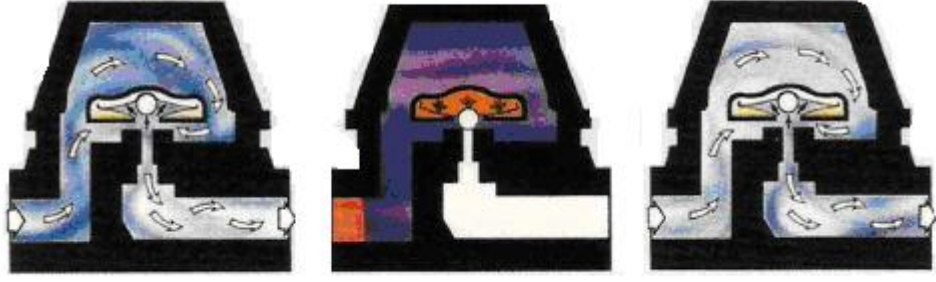
Şekil 3.7. Termostatik kondensstopun çalışma prensibi [14]
