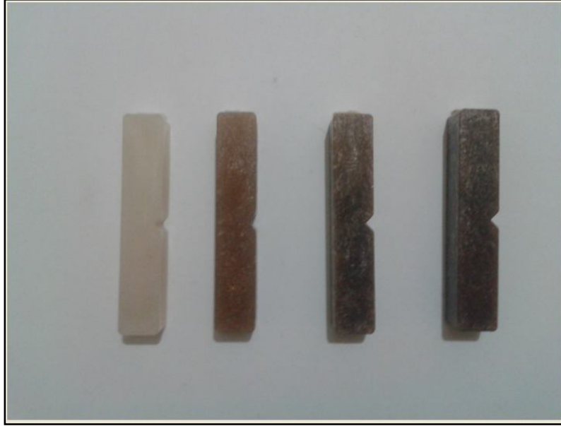
Şekil 5.4. Saf PP, %5, %10 ve %15 ahşap tozu takviyeli izod darbe deney numuneleri.
