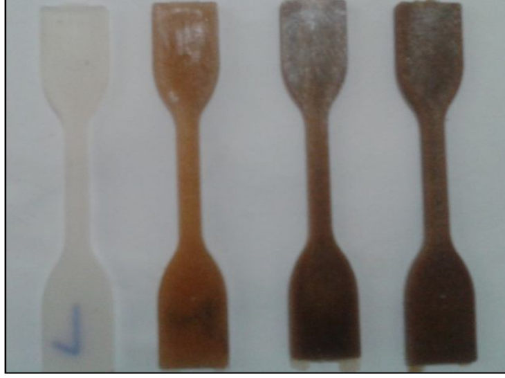
Şekil 5.3. Saf PP, %5, %10 ve %15 ahşap tozu dolgulu çekme deney numuneleri.
