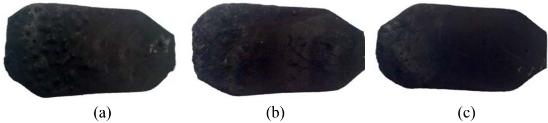
Şekil 7.16. Dikey yanma test sonuçları a) 9 numaralı numunenin dikey yanma test sonucu, b) 10 numaralı numunenin dikey yanma test sonucu, c) 11 numaralı numunenin dikey yanma test sonucu.
