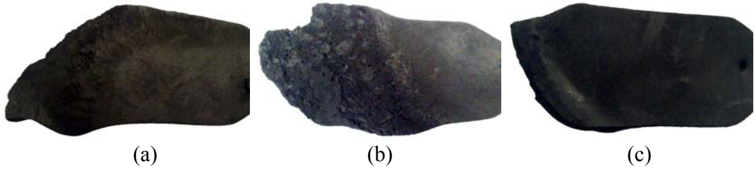
Şekil 7.15. Dikey yanma test sonuçları a) 6 numaralı numunenin dikey yanma test sonucu, b) 7 numaralı numunenin dikey yanma test sonucu, c) 8 numaralı numunenin dikey yanma test sonucu.
