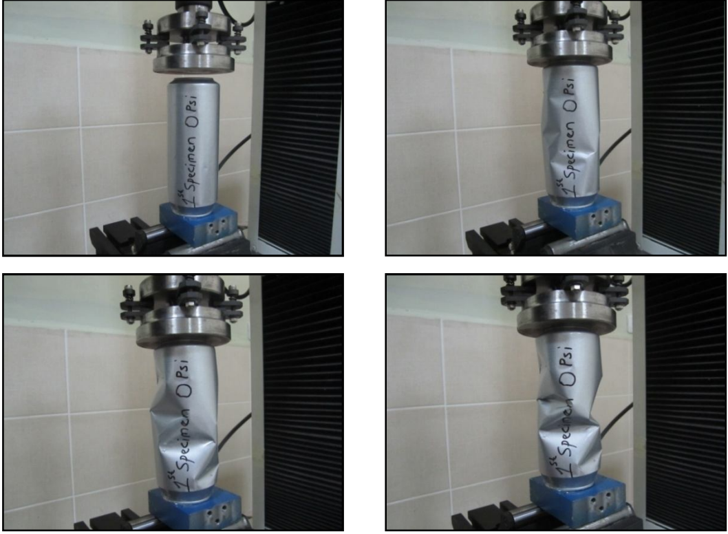
Şekil 5.7. Autograph marka test cihazında basma deneyinin uygulama şekli.
