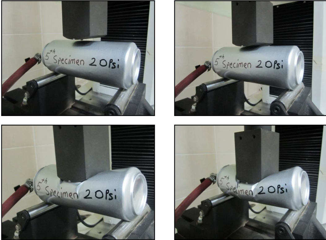
Şekil 5.5. Autograph marka test cihazında eğme deneyinin uygulama şekli
