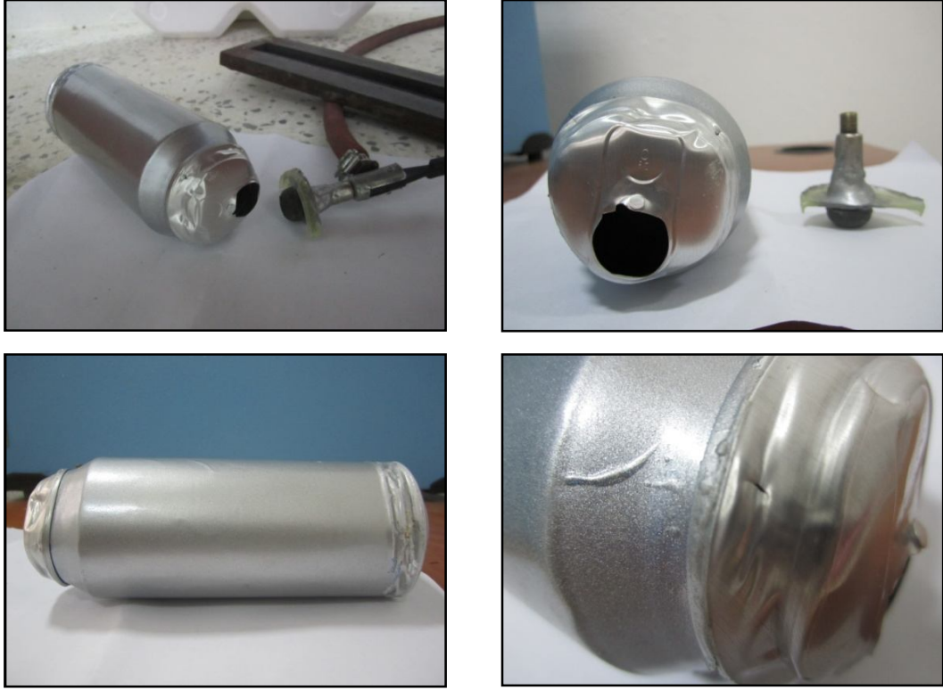
Şekil 5.3. Alüminyum tüp de patladıktan sonra oluşan hasarlar.
