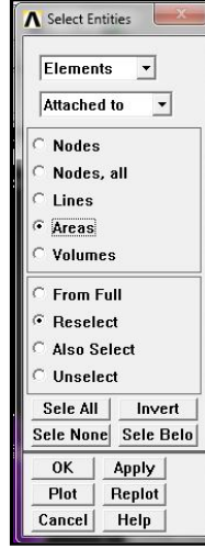
Şekil 4.35. Alüminyum tüpün alt-üst kapaklarının alanlarına ve yanal alanlarına bağlı elemanların seçilmesi.
