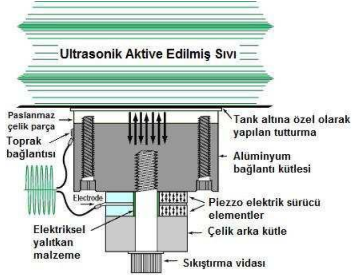
Şekil 2.18. Piezoelektrik dönüştürücünün yapısı ve montajı [17].
