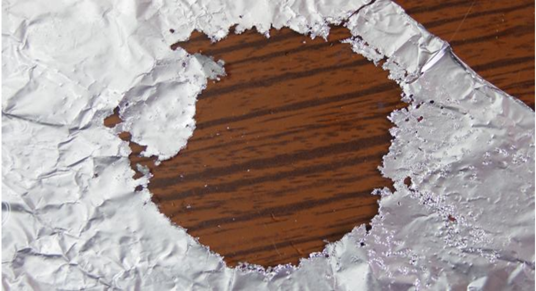
Şekil 4.7. Homojen olmayan kavitasyon baloncuğunun temizleme etkisi.
