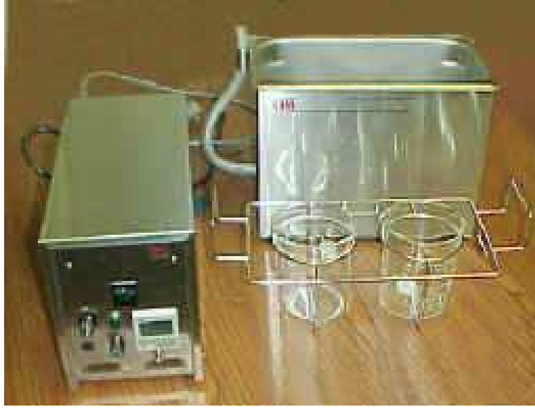
Şekil 2.25. Yanıcı çözeltili kullanılan bir temizleme sistemi [24].
