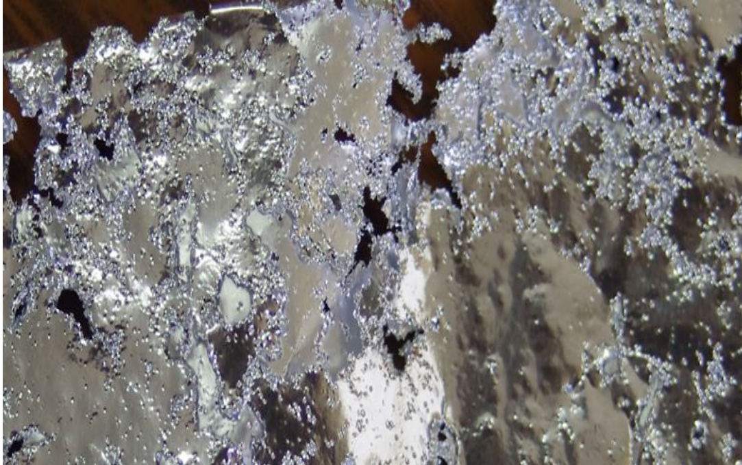
Şekil 4.6. Kavitasyon baloncuklarının alüminyum folyoya etkisi.
