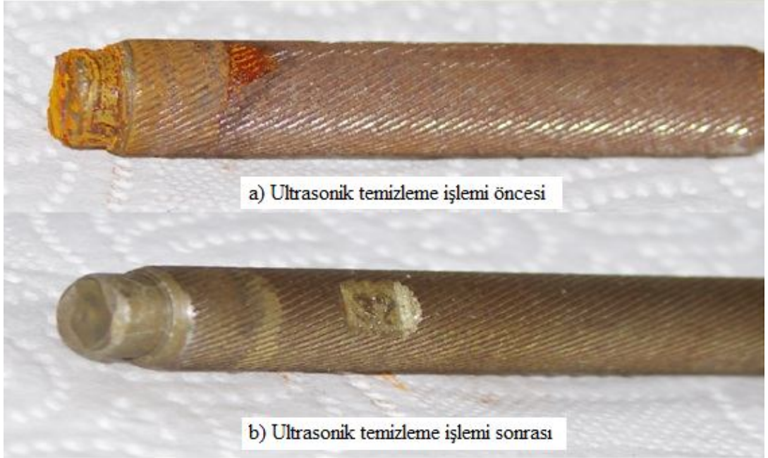
Şekil 4.5. Paslı malzemenin temizlik öncesi ve sonrası fotoğrafı.
