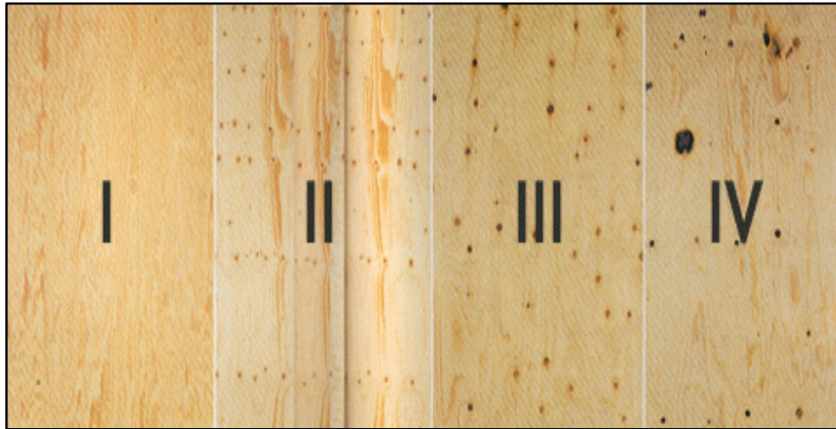
Şekil 3.4. Ağaç malzeme kereste kalitesinin belirlenmesi.
