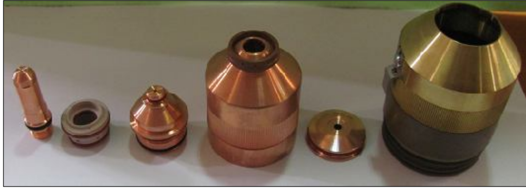
Şekil 2.7. Torç ünitesini oluşturan elemanların fotoğraf görüntüsü.
