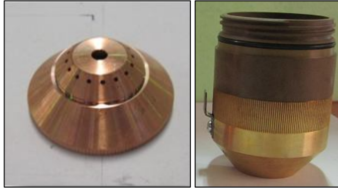
Şekil 2.12. Koruyucu kap ve başlığı görüntüsü.
