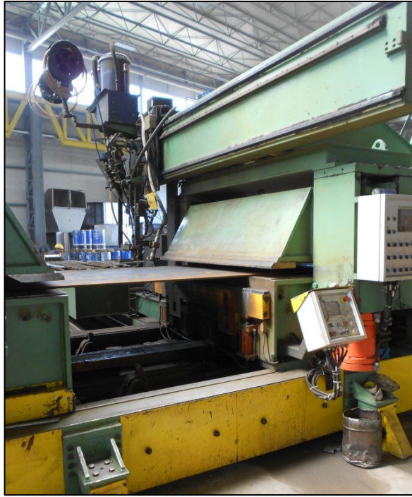
Şekil 5.2. Deneysel çalışmalarda kullanılan tozaltı ark kaynak makinesi.
