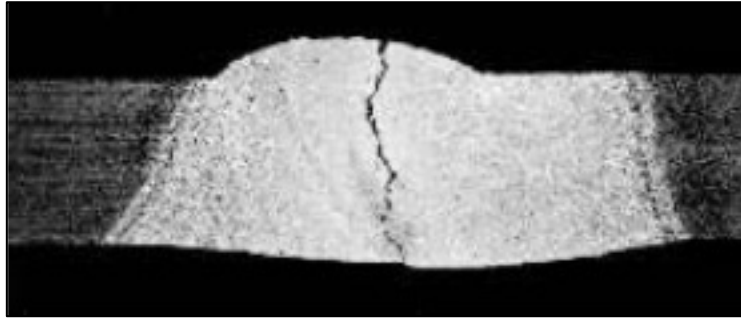
Şekil 2.17. Kaynak dikişinde sıcak çatlama örneği [8].
