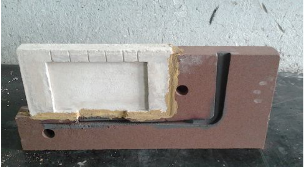
Şekil 4.3. Lod 607 Seramik malzeme ile hazırlanan kalıp görüntüsü.
