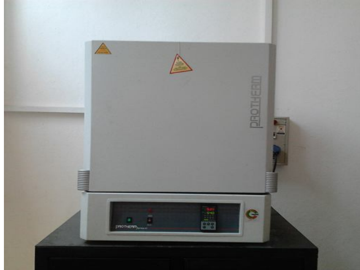
Şekil 4.10. Yaşlandırma ısıt işleml yapılan fırın görüntüsü.
