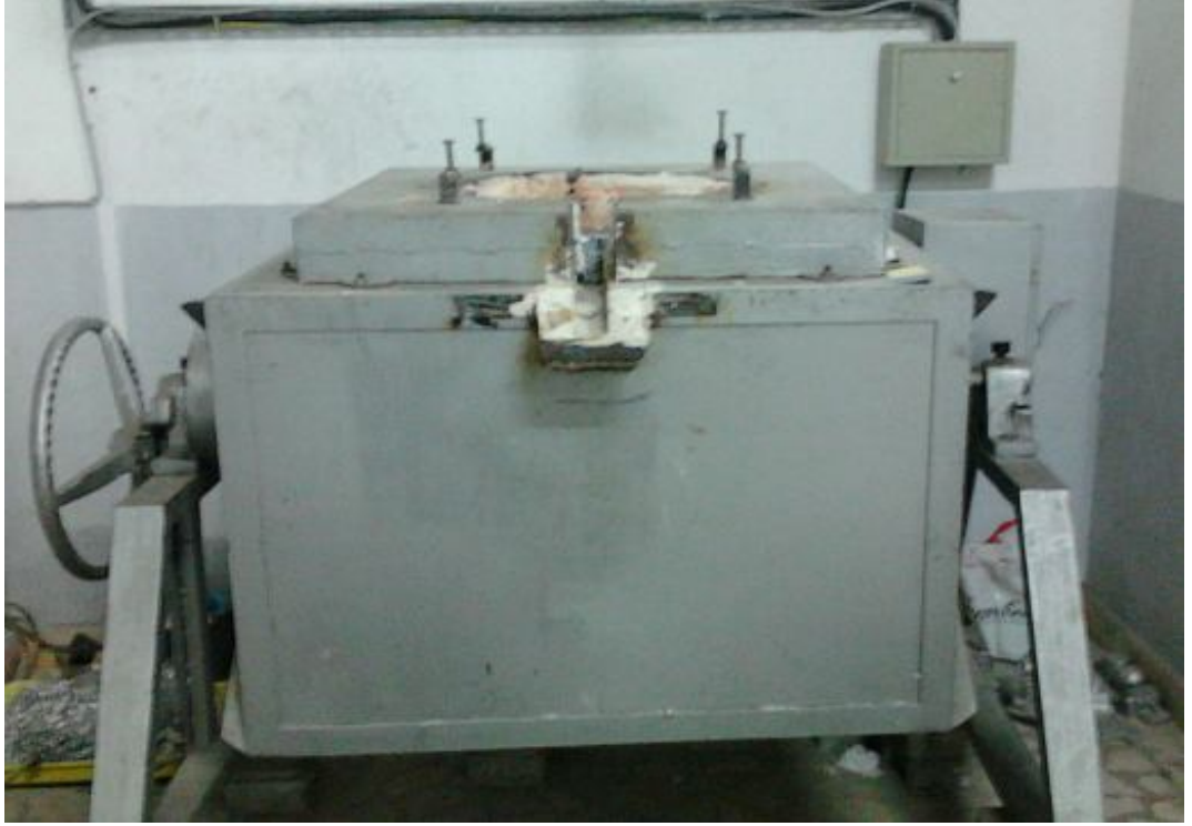
Şekil 4.5. Ergitme işleminde kullanılan elektrik direnç ocağı görüntüsü.
