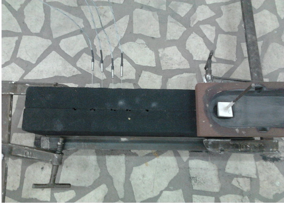
Şekil 4.9. Kalıba yerleştirilen ısı çiftlerinin gerçek görüntüsü.
