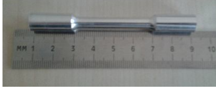
Şekil 4.14. Çekme numunesi görüntüsü.
