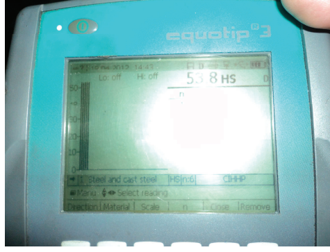
Şekil 3.12. Sertlik ölçme cihazı.
