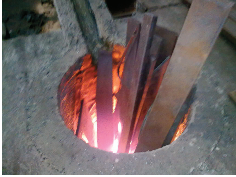
Şekil 3.3. Bir tonluk indüksiyon ocağı.
