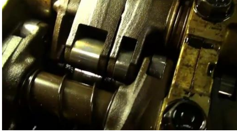
Şekil 3.9. SOHC VTEC motor üzerinde külbütörlerin görünümü.
