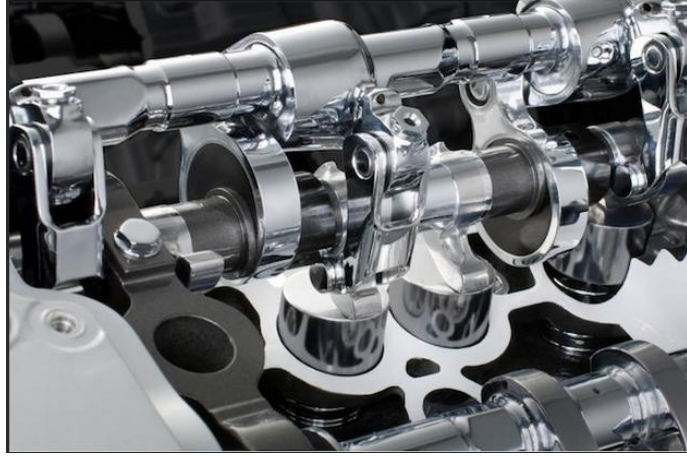
Şekil 3.19. Nissan VVEL'in motor üzerindeki görüntüsü [20].
