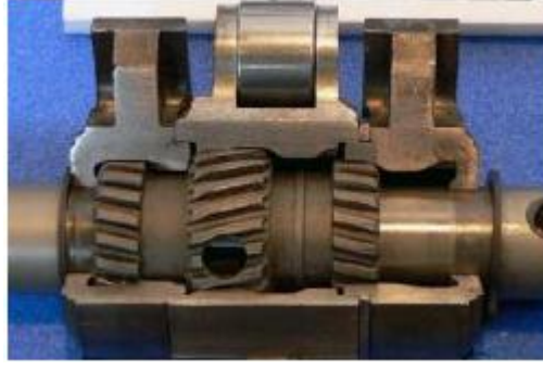
Şekil 3.14. Değişken yükseklik ayarlama mekanizması [20].
