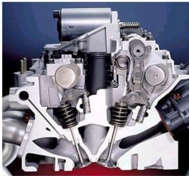
Şekil 3.17. Valvetronic'in motor üzerindeki görünümü [20].
