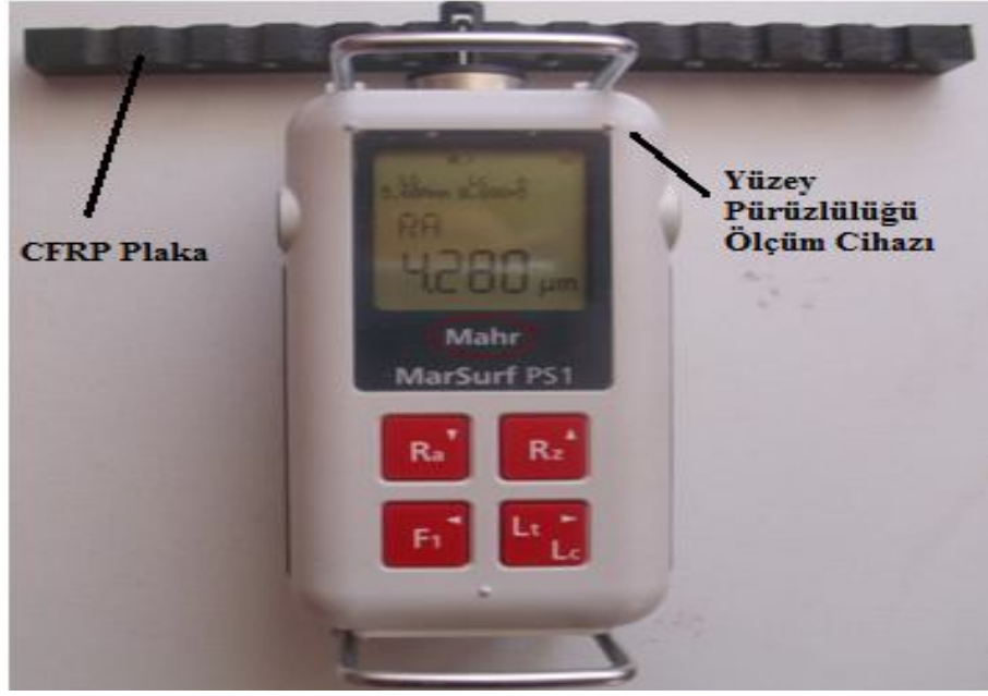
Şekil 3.12. Delinen deliklerin yüzey pürüzlülüğün ölçülmesi.
