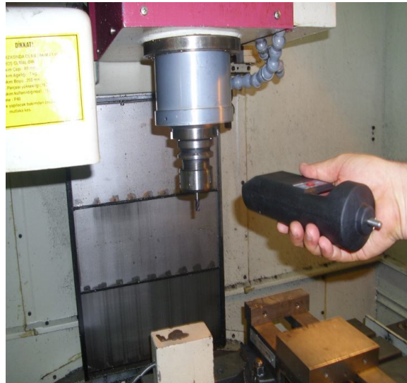
Şekil 3.7. İş mili devrinin ölçümü.
