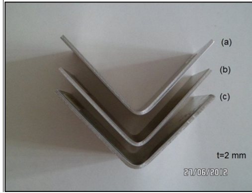
Şekil 5.14. 90°de bükülen AA 5754-O deney numuneleri: a) Zımba uç yarıçapı 2 mm, b) Zımba uç yarıçapı 4 mm, c) Zımba uç yarıçapı 6 mm.
