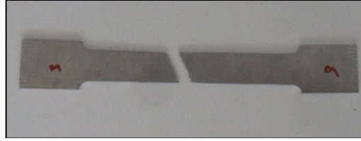
Şekil 5.20. AA 5754-O numunede çekme testi sonucu meydana gelen kırılma.
