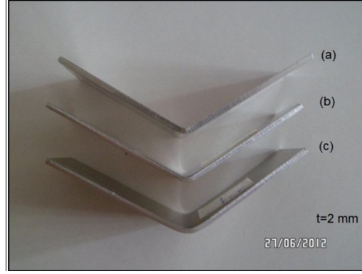
Şekil 5.16. 120°'de bükülen AA 5754-O deney numuneleri: a) Zımba uç yarıçapı 2 mm, b) Zımba uç yarıçapı 4 mm, c) Zımba uç yarıçapı 6 mm.
