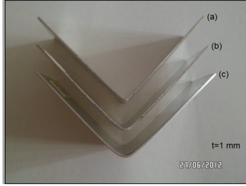
Şekil 5.7. 90°'de bükülen Al 1050-O deney numuneleri: a) Zımba uç yarıçapı 2 mm, b) Zımba uç yarıçapı 4 mm, c) Zımba uç yarıçapı 6 mm.
