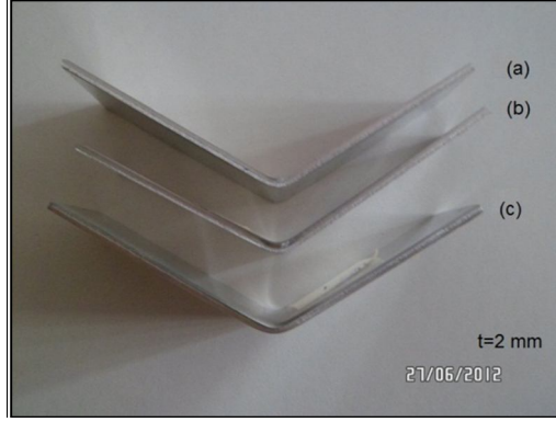
Şekil 5.10. 120°de bükülen Al 1050-O deney numuneleri: a) Zımba uç yarıçapı 2 mm, b) Zımba uç yarıçapı 4 mm, c) Zımba uç yarıçapı 6 mm.
