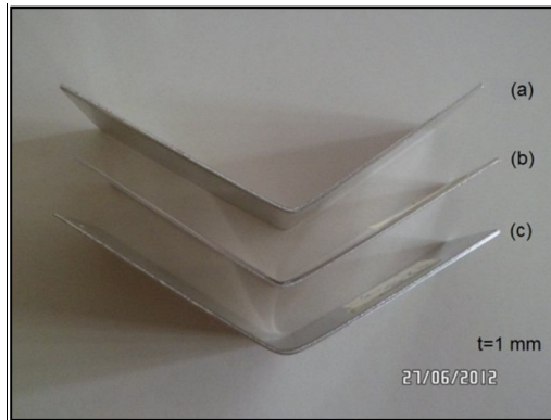
Şekil 5.9. 120°'de bükülen Al 1050-O deney numuneleri: a) Zımba uç yarıçapı 2 mm, b) Zımba uç yarıçapı 4 mm, c) Zımba uç yarıçapı 6 mm.
