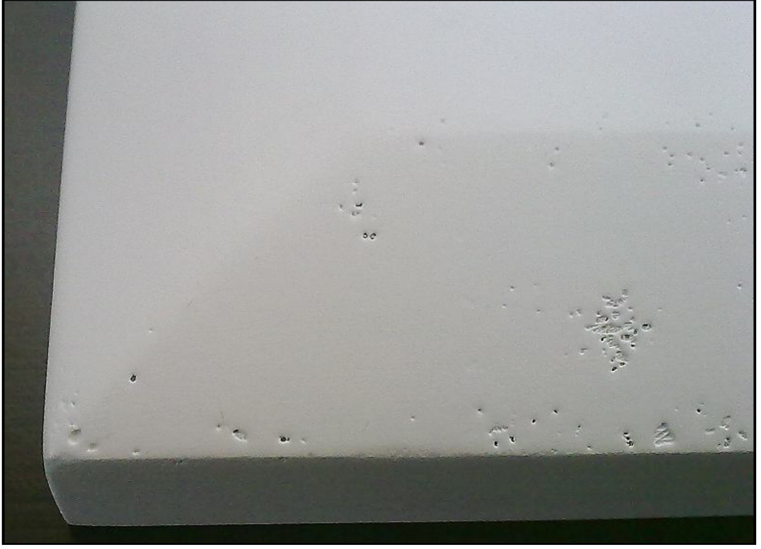
Şekil 3.1. Polyester astar üzerine kortel+polyester uygulanmış parça yüzeyindeki delikli görüntü.
