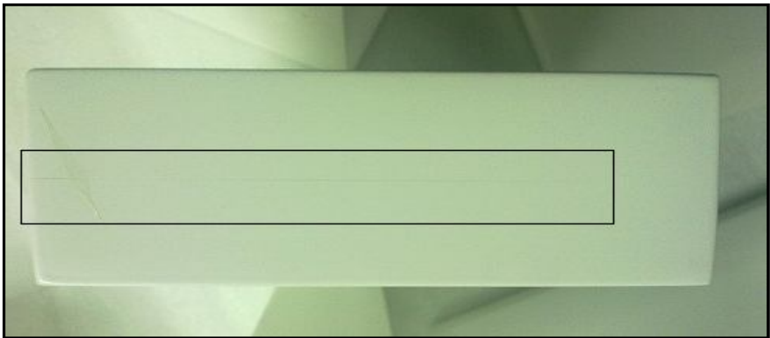
Şekil 3.12. Döngü 17 non-crack 18+18 düz kalınlaştırmalı parçada hafif çatlak başlaması.
