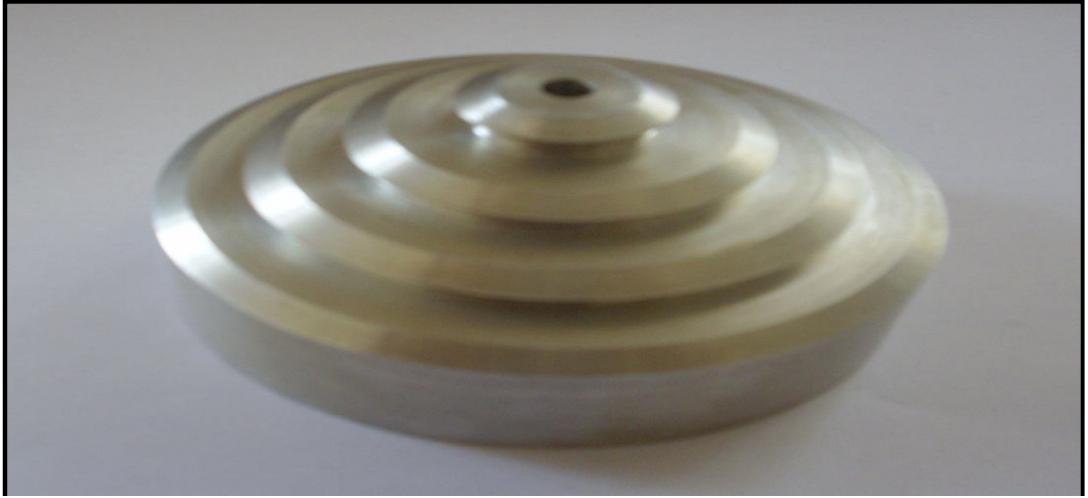
Şekil 2.25. Deney alanına yerleştirilecek olan ısı kaynağı (alüminyum blok).
