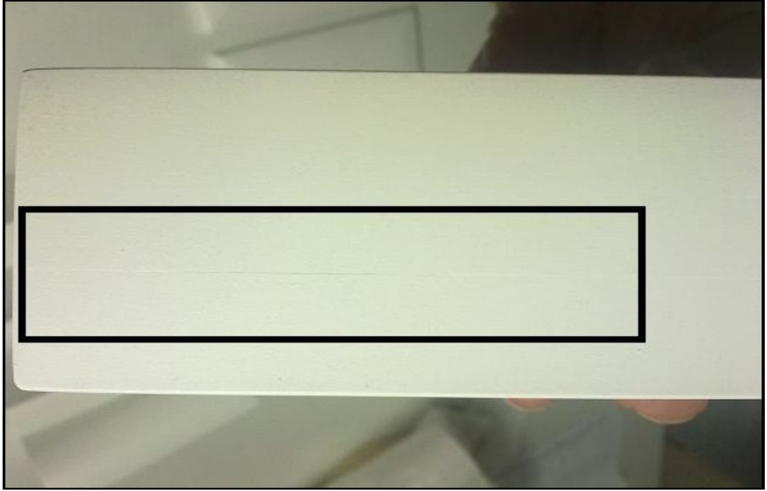
Şekil 3.6. Poliüretan astarlı reward tipi parçada hafif çatlak başlaması (Döngü 3).
