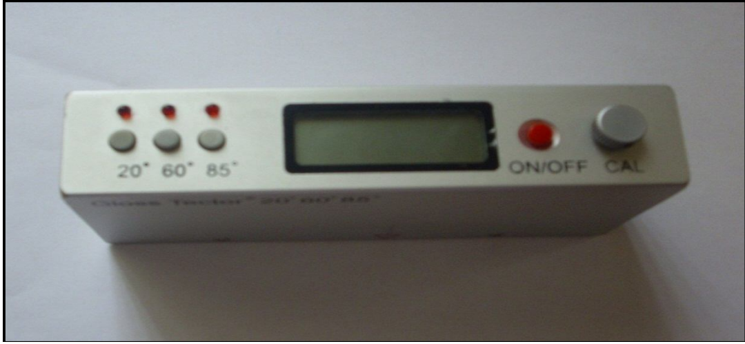
Şekil 2.22. Gloss-metre parlaklık ölçüm cihazı.
