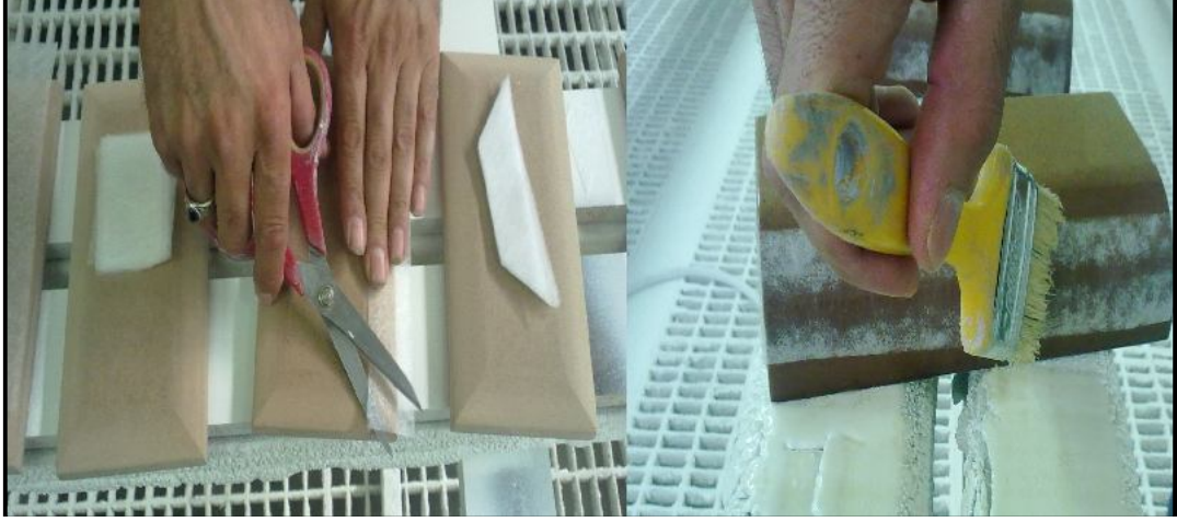
Şekil 2.12. Kortel+polyesterin parça tipine ve kesitine göre hazırlanması.
