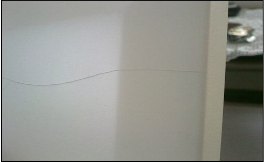
Şekil 3.15. Kristal pah kırılarak hazırlanmış poliüretan astarlı parçada çatlağın yakın görüntüsü.
