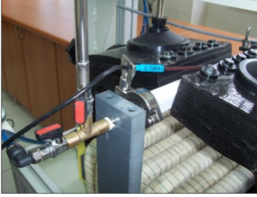
Şekil 4.14. Manyetik alan indüksiyonu ölçümünün fotoğraf görüntüsü.
