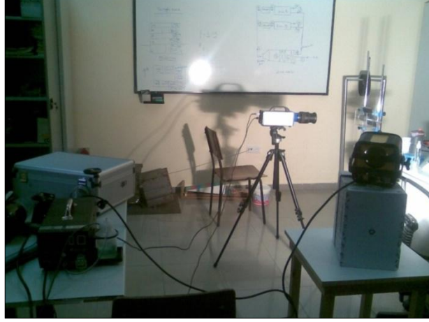
Şekil 4.4. Hızlı kamera ile akış görüntüleme deney düzeneği.
