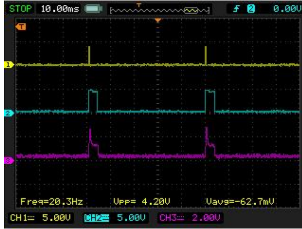
Şekil Ek B.8. 0° KMA avans değerinde tam tur, enjektör kontrol sinyalleri ve çekilen akım
