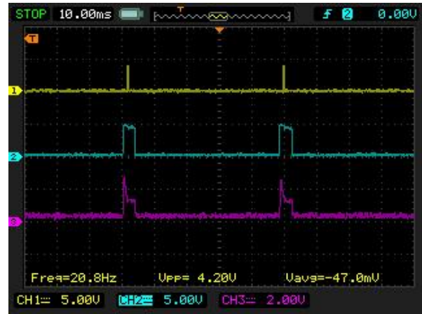
Şekil Ek B.6. 10° KMA avans değerinde tam tur, enjektör kontrol sinyalleri ve çekilen akım
