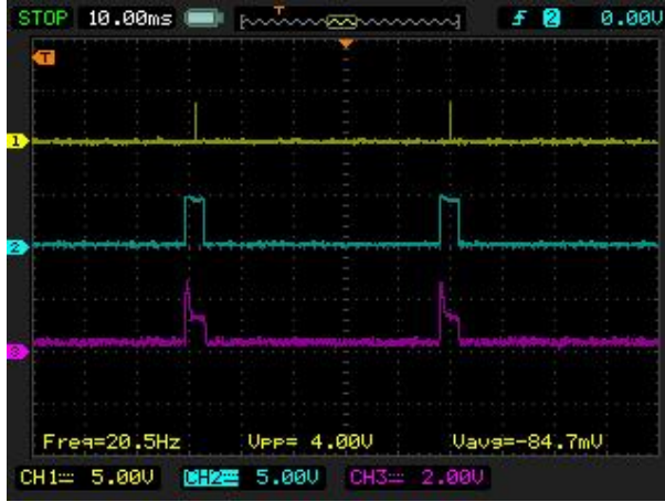
Şekil Ek B.5. 15° KMA avans değerinde tam tur, enjektör kontrol sinyalleri ve çekilen akım
