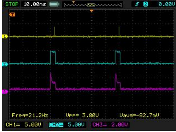
Şekil Ek B.4. 20° KMA avans değerinde tam tur, enjektör kontrol sinyalleri ve çekilen akım
