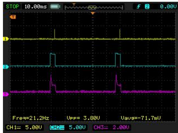
Şekil Ek B.3. 25° KMA avans değerinde tam tur, enjektör kontrol sinyalleri ve çekilen akım
