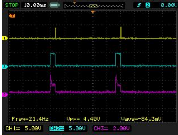
Şekil Ek B.2. 30° KMA avans değerinde tam tur, enjektör kontrol sinyalleri ve çekilen akım
