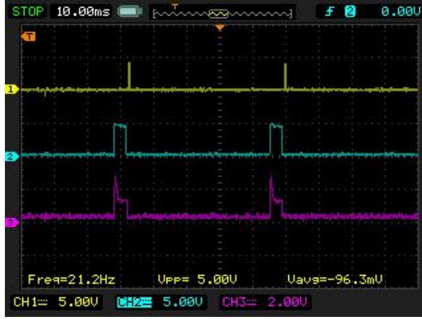
Şekil Ek B.1. 35° KMA avans değerinde tam tur, enjektör kontrol sinyalleri ve çekilen akım
