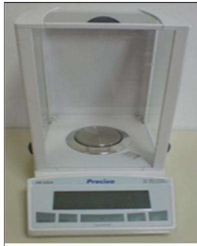
Şekil 5.7. Ağırlık kayıplarının belirlenmesinde kullanılan Precisa marka XS 220A model hassas terazi.
