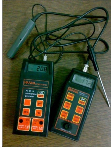
Şekil 5.8. Çözeltilerin Sıcaklık, Ph ve iletkenlik değerlerini ölçmede kullanılan HANNA marka ölçüm cihazları.
