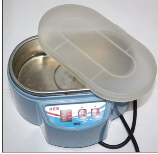
Şekil 5.6. Numune temizleme işlemlerinde kullanılan BEB marka ultrasonik temizleme cihazı.
