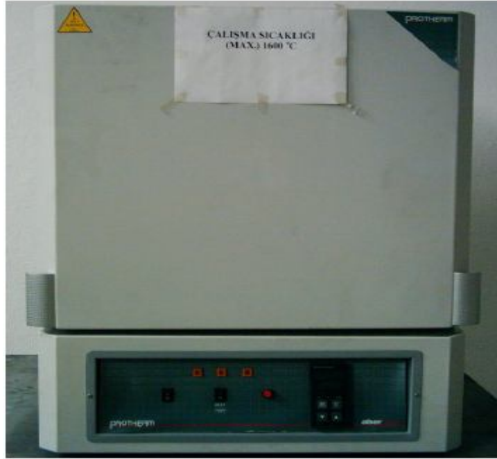
Şekil 5.4. Isıl işlem uygulamalarında kullanılan Protherm marka ısıl işlem fırını.
