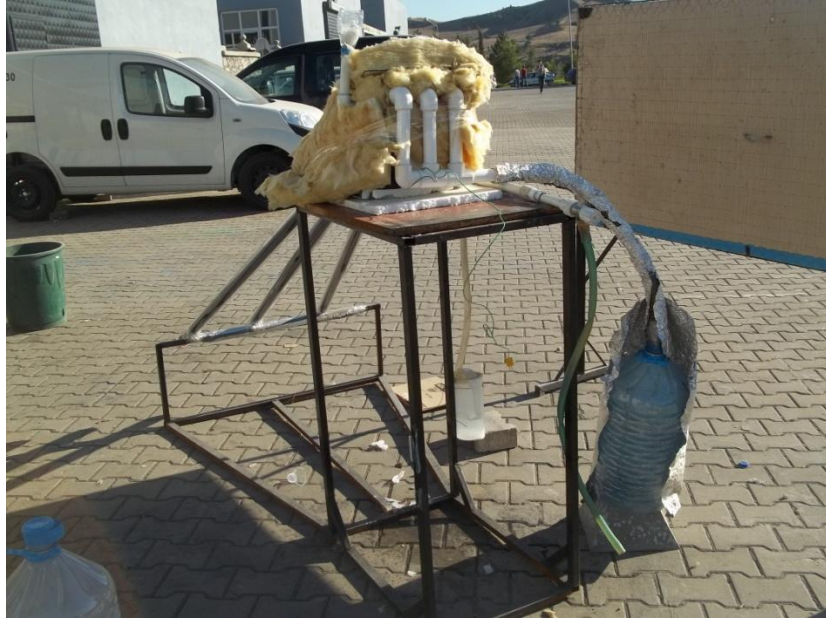
Şekil 5.10. Güneş enerjili damıtma sistemi arkadan görünüşü.
