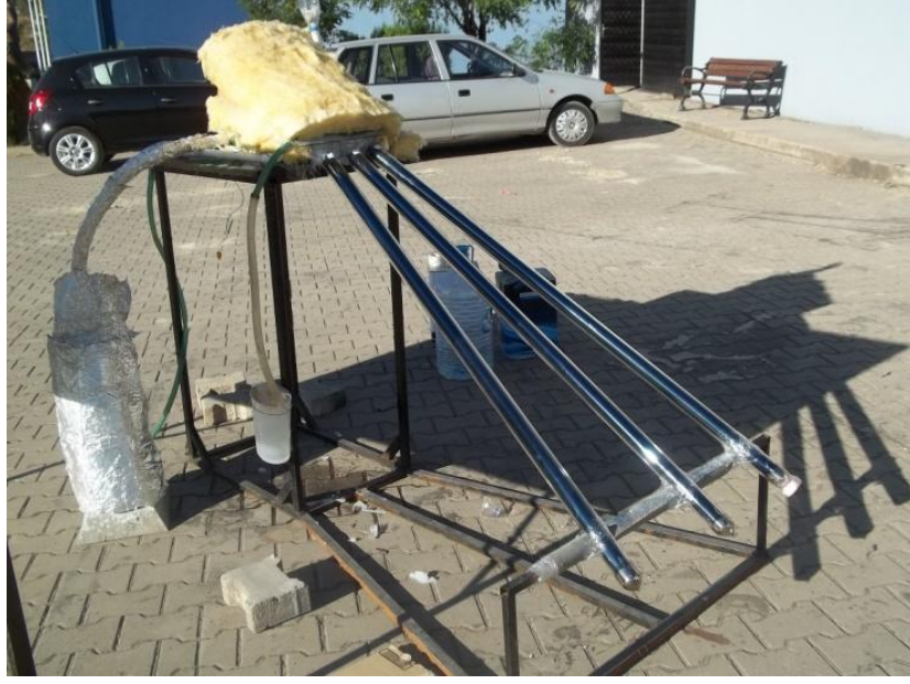
Şekil 5.9. Deneyde kullanılan güneş enerjili damıtma sistemi yandan görünüşü.
