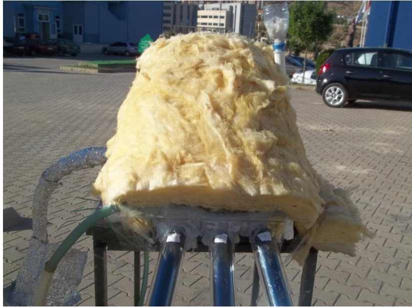
Şekil 5.12. Güneş enerjili damıtma sistemi üst yoğuşma örtüsü.
