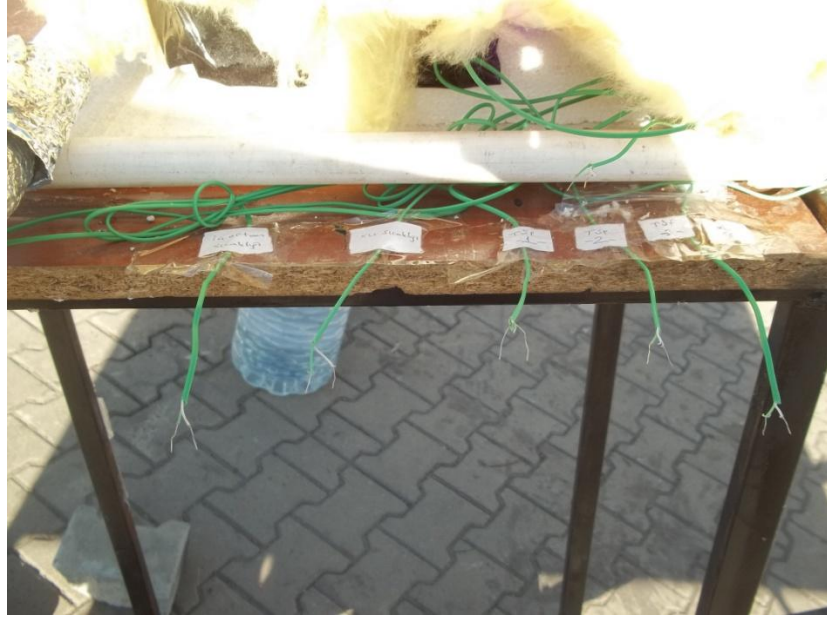
Şekil 5.13. Deneyde kullanılan güneş enerjili damıtma sistemine bağlı termokupllar.
