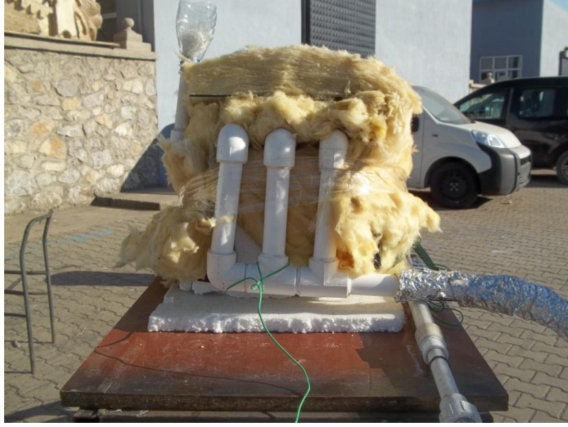
Şekil 5.11. Güneş enerjili damıtma sistemi toplama kanallarının görünüşü.
