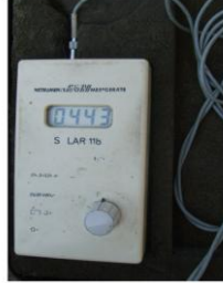
Şekil 5.1. Işınım şiddetini ölçen solarimetre.
