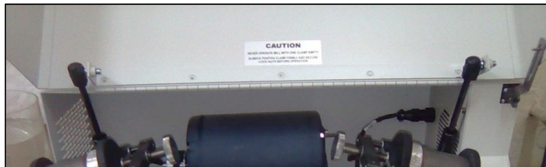
Şekil 5.2. Toz konan öğütücü hazneler ve bilyalar.
