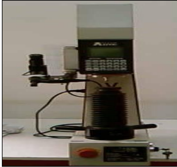
Şekil 5.6. Sertlik ölçümlerinin yapıldığı universal makro sertlik cihazı.
