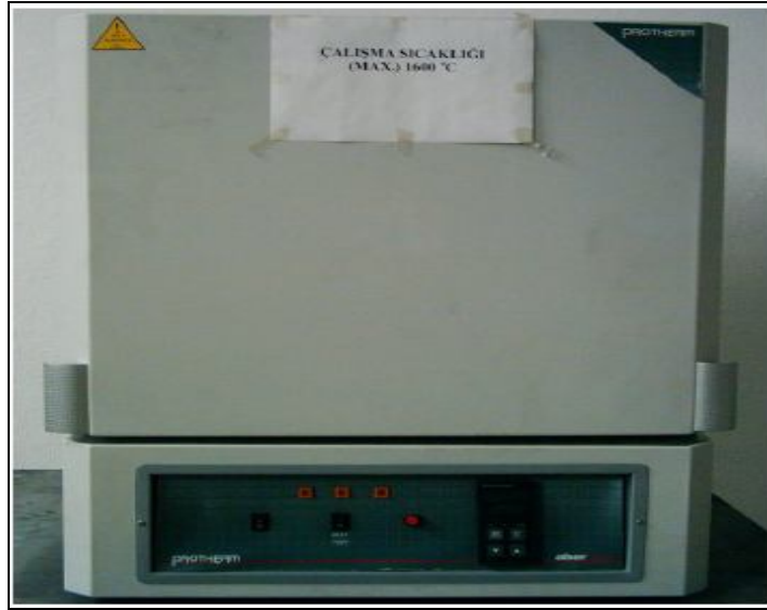
Şekil 5.5.Sentezleme işleminde kullanılan Protherm marka ısıtma fırını.
