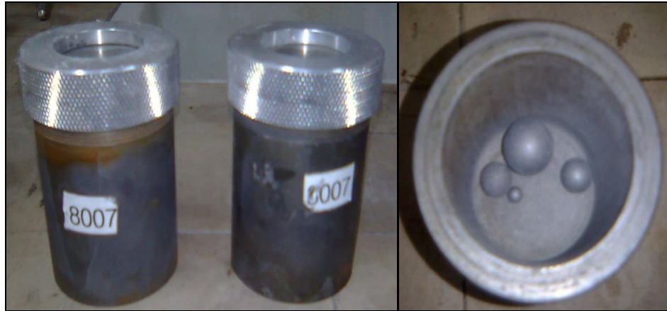
Şekil 5.2. Toz konan öğütücü hazneler ve bilyalar.
