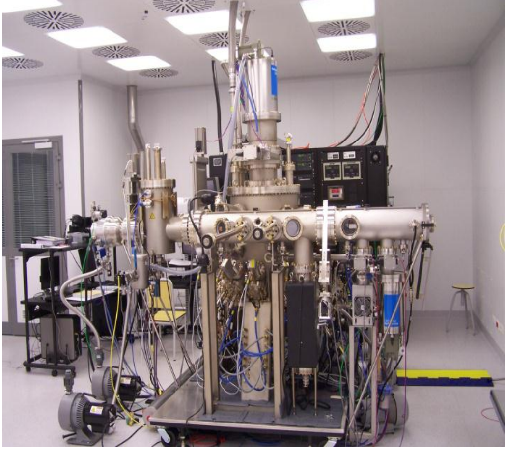
Şekil 1.1. Anadolu Üniversitesi, Nanoboyut Araştırma Laboratuvarı'nda kurulu MBE sisteminin genel görünüşü.
