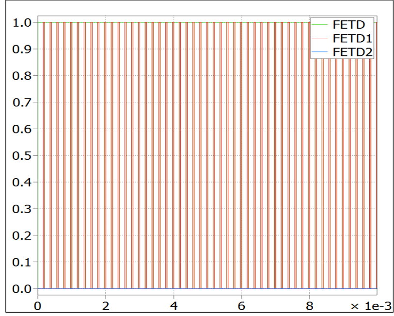
Şekil 6.14. Alçaltan Modda % 80 görev süresi oranında gerçekleştirilmiş simülasyona ait anahtarlama elemanları tetikleme sinyali grafiği.
