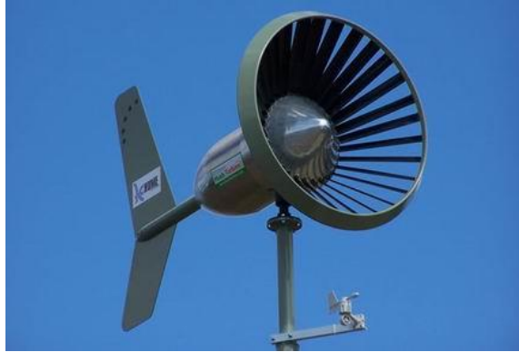
Şekil 2.3. Arthur O'Connor tarafından geliştirilen yatay rüzgâr türbini.
