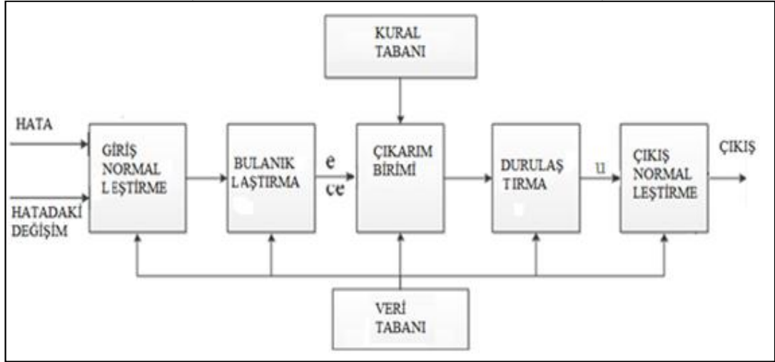
ekil 3.6. Bulanık mantık denetleyicinin temel yapısı.
