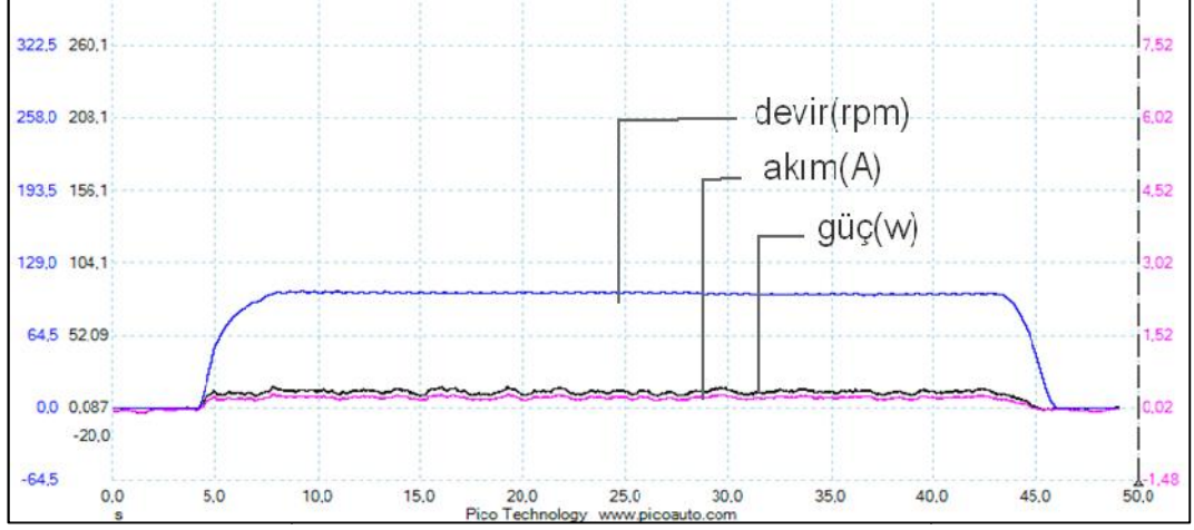
ekil 5.2. Yüksüz sistemde motora ait sürücünün 100 rpm'deki ölçüm sonuçları.
