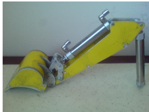
b) Kepçe ile stik kolun bağlantısı.
