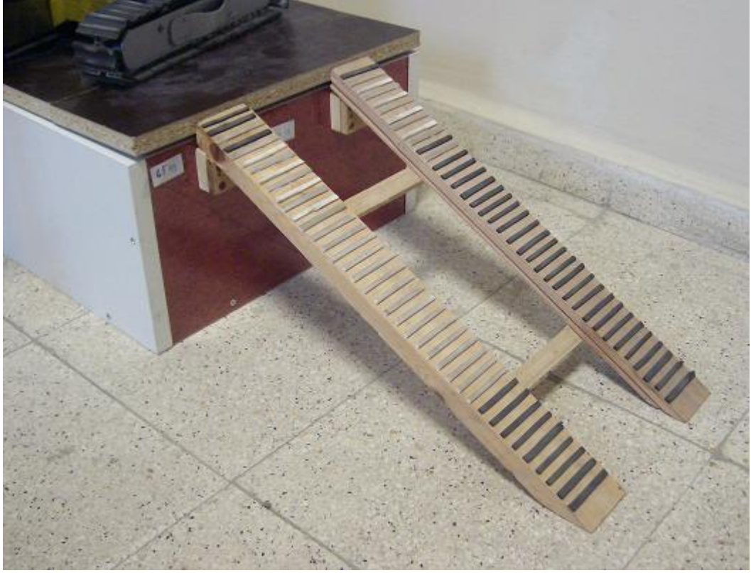
Şekil 5.7. Ekskavatörü Rampa üzerine çıkarma-indirme deney ortamı.
