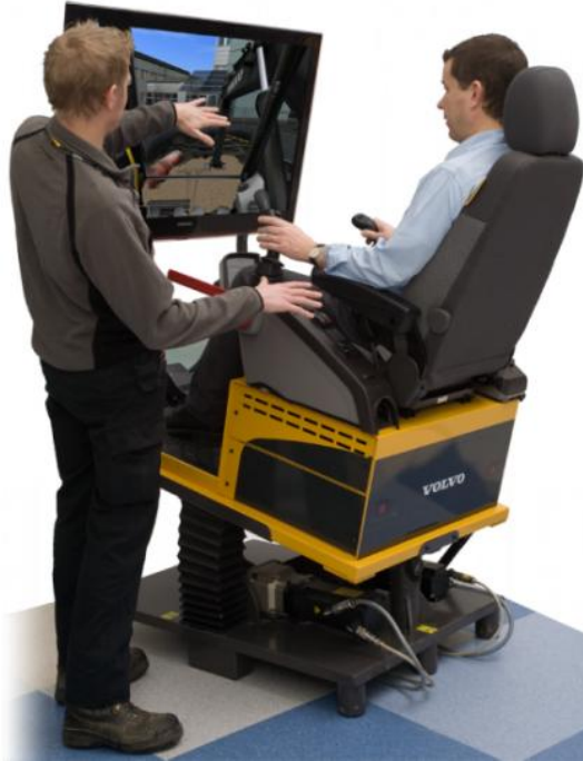
a) Hareketli koltuk ile sanal ortamda çalışma.
