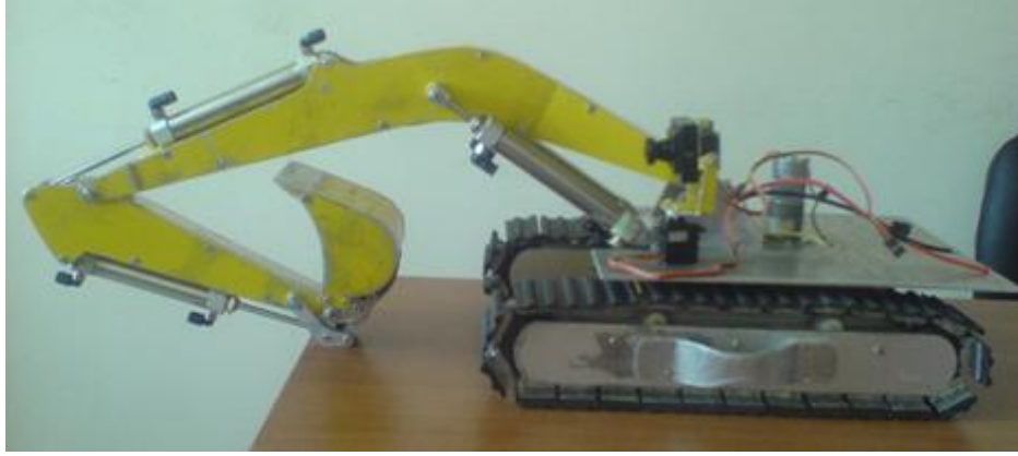
a) Kol mekaniğinin üst tablaya bağlantı yapısı.
