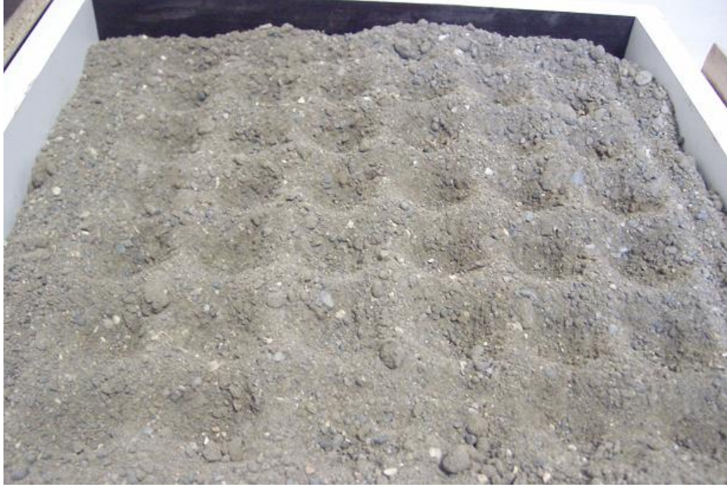
Şekil 5.5. Zemin düzeltme uygulaması deney ortamı.
