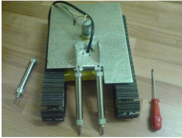
Şekil 3.12. Bom kolu ve silindirlerinin bağlantı noktaları.
