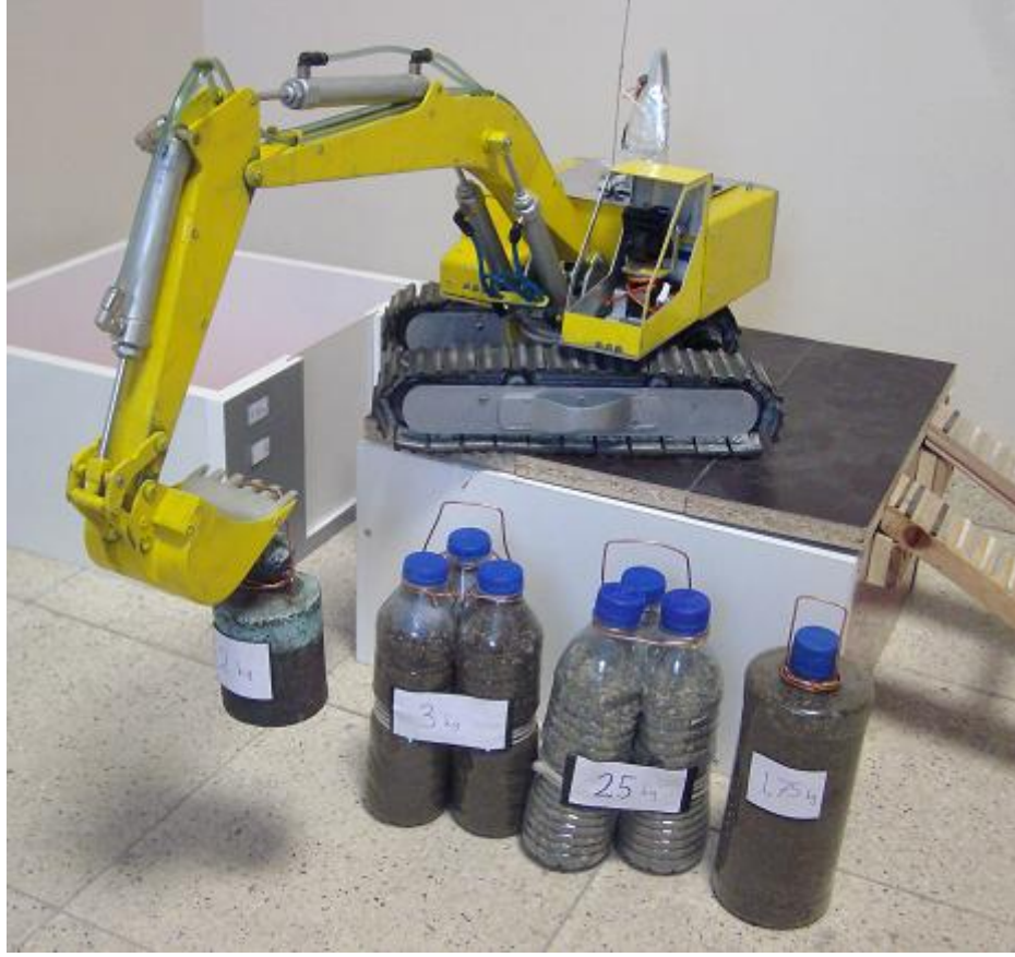
Şekil 5.9. Ekskavatörü vinç olarak kullanma deney ortamı.
