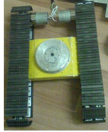
b) Palet sistemi üst görünüşü.
