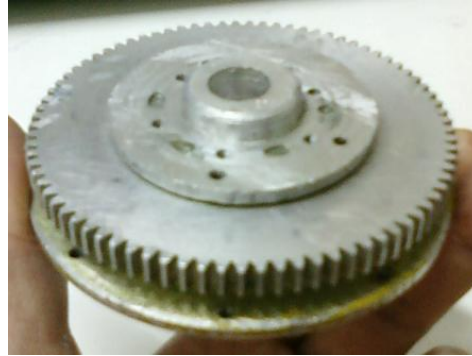
Şekil 3.6. Üst yapının dönüşünü sağlayan merkez dişli.
