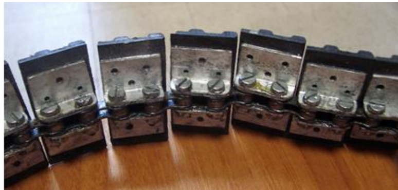
řekil 3.8. Palet zinciri yapısı.
