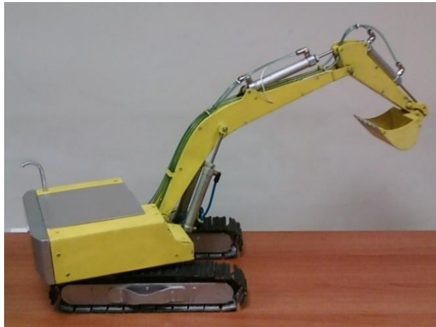
d) Boyaması yapılarak tamamlanmış ekskavator modeli.
