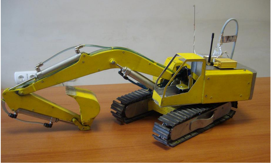
Şekil 1.3. İmalatı gerçekleştirilen ekskavatör robot.
