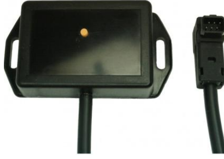
Şekil 4.14. DT-3K Hybrid head tracker (hareket takip cihazı).
