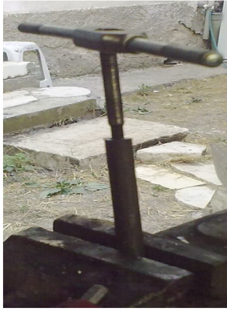
Şekil 5.11. M6'ya uygun iç çapına diş açılmıştır.
