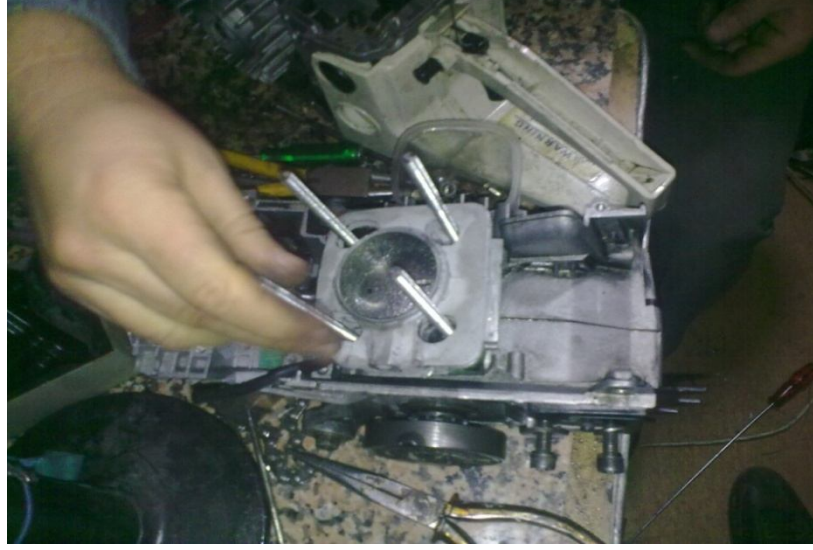
Şekil 5.12. Motorun alt kısmıyla (karter, krank, piston ve biyel takımı) silindirlerin saplamalarla bağlantısı.
