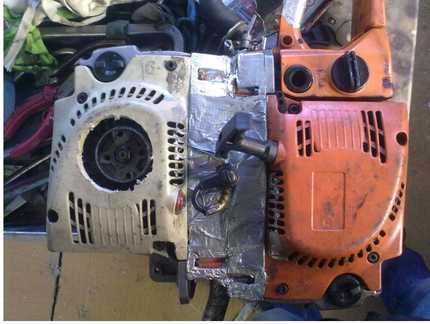
Şekil 5.25. Volanlar üzerinde hava sirkülasyonu sağlayan kapakların takılmış hali.
