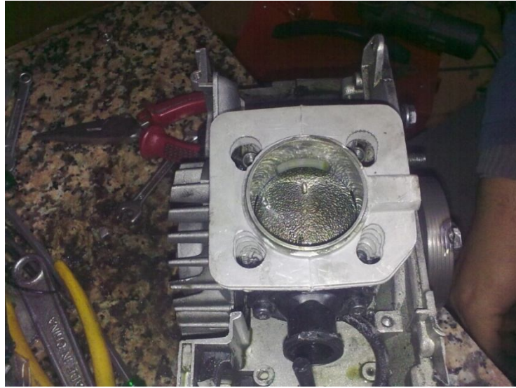
Şekil 5.13. Montajda karşılık gelen alt kısım ve silindirin takılışı.
