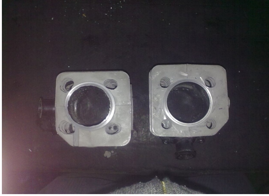
Şekil 5.4. Üst ölü noktaları kesilmiş silindirler.
