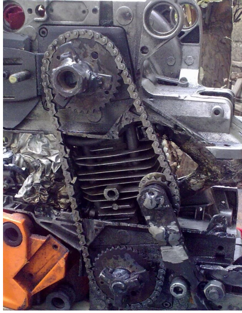
Őekil 5.20. Krankların zincir ve gergisiyle baęlanmış hali.
