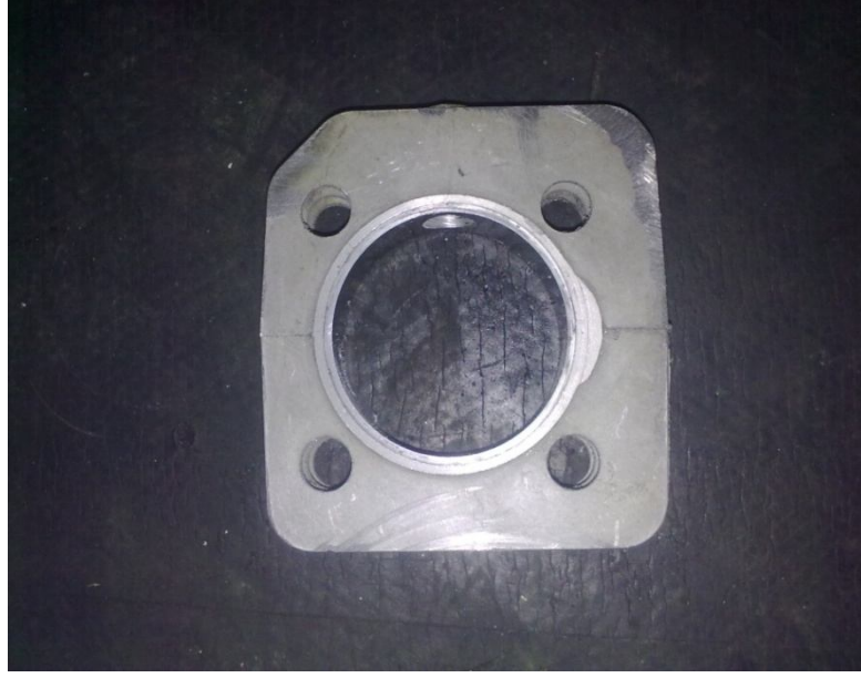
Şekil 5.5. Yanma odasının oluşturulduğu ve bujinin takıldığı orta parça.
